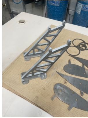
Figura 83. Soportes de aluminio cortados en chorro de agua. (fuente:propia)
