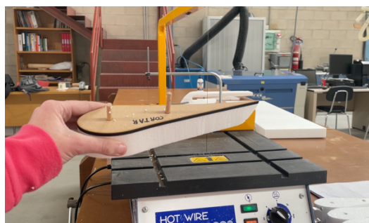
Figura 71. Perfil de espuma cortado en hilo caliente. (Fuente: propia)
