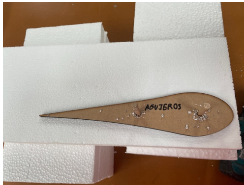
Figura 69. Utilización de perfil de madera como plantilla de corte. (Fuente: propia)
