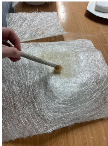
Figura 82. Proceso de impregnación de la fibra de vidrio. (Fuente:propia)
