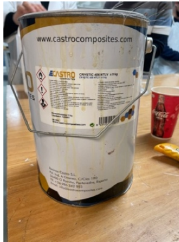
Figura 78. Resina de poliéster usada para recubrimiento de fibra de vidrio. (Fuente: propia)
