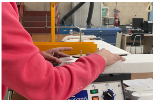
Figura 70. Corte de perfiles de espuma. (Fuente: propia)
