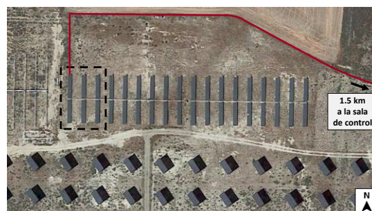
Fig. 1. Imagen de la estación fotovoltaica del estudio. En el recuadro negro: seguidores estudiados. Línea roja: ruta de la fibra óptica de comunicación. Obtenido de Google – Gobierno de Navarra y el Inst. Geográfico Nacional.
