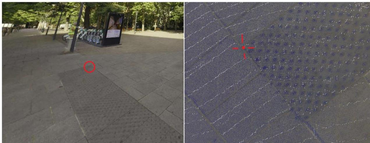
**Figura 14.** Perspectiva de la cámara 360 RGB desde la posición de uno de los puntos de escaneos (derecha). Visualización del punto en la nube de puntos para obtener la posición exacta (izquierda).
