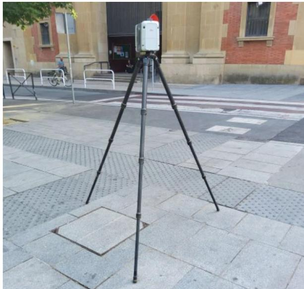
**Figura 6.** Fotografía tomada en el momento de la adquisición de datos del sensor TLS montado en un trípode en la Plaza de la Cruz.
