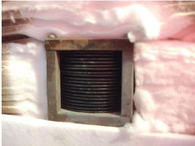
*Figura 3. 7 Receptor forrado con aislante cerámico*
