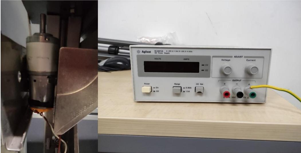
Figura 3. 8 Motor DC con reductora y fuente de alimentación
