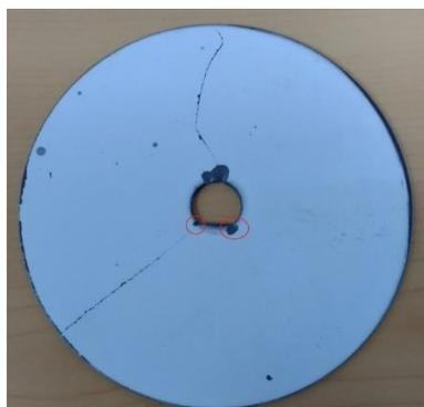
*Figura 5. 1 Disco roto de la primera versión sin optimizar del concepto de discos. El aplastamiento para unir discos con eje forma un concentrador de tensiones donde se inicia la grieta.*
