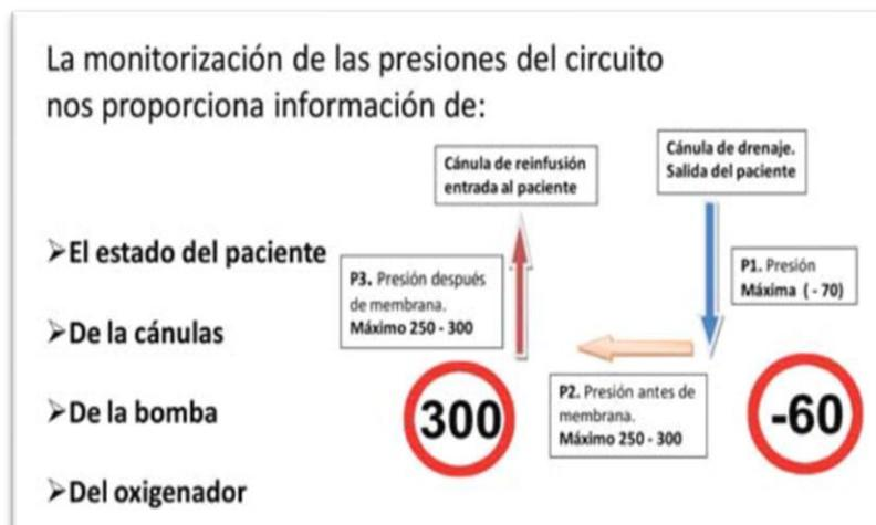
**Figura 7.** Monitorización presiones circuito ECMO
