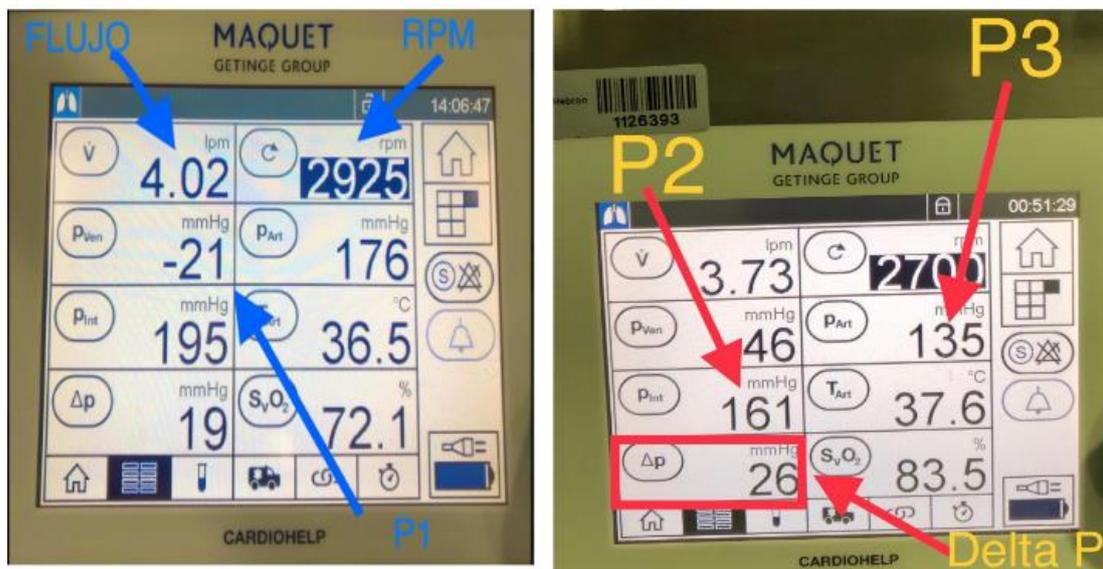
**Ilustración 5.** Partes consola Cardiohelp de Maquet
