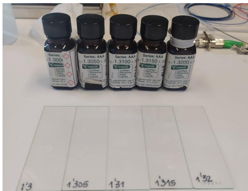
Figura 5-11 Fotografía con diferentes portaobjetos en los que depositar las gotas de los líquidos con índices de refracción entre 1,3 y 1,32 para la posterior medición.
