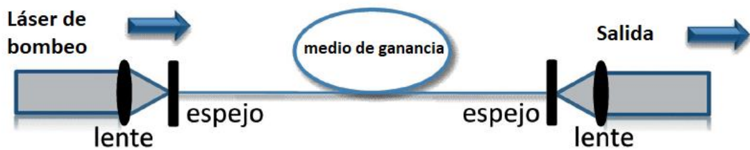
Figura 1-11 Configuración básica de un láser de fibra óptica. [27]
