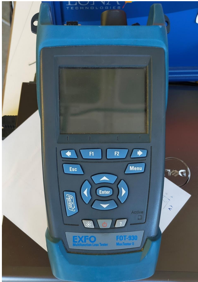
Figura 2-12 Fotografía del power meter que se utilizará en el laboratorio en las mediciones de potencia óptica.
