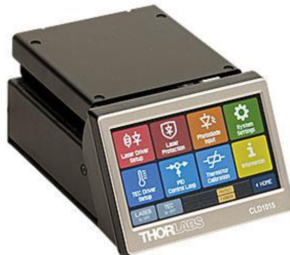
Figura 2-6 Controlador del láser de bombeo utilizado en el proyecto.[35]
