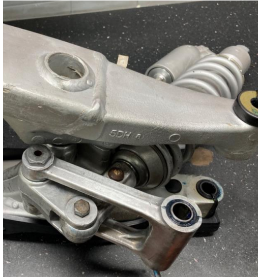
Ilustración 15: Sistema de suspensión trasera por Bieletas. [22]
