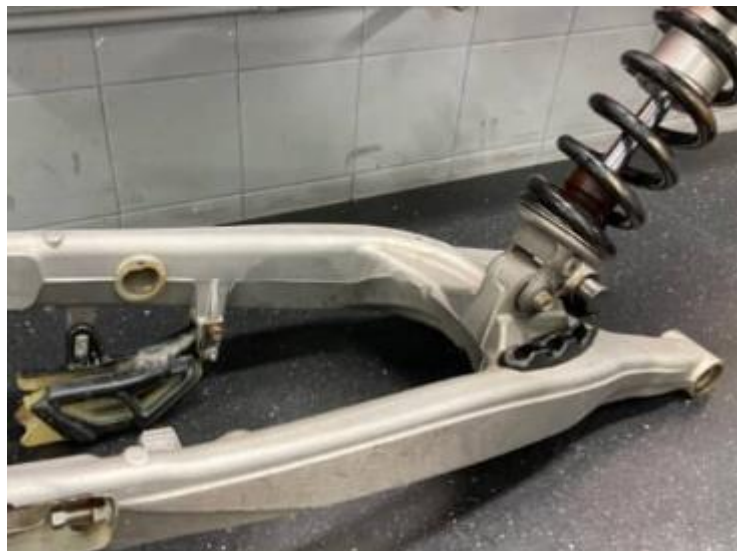
Ilustración 14: Sistema de suspensión trasera por Conexión Directa. [22]
