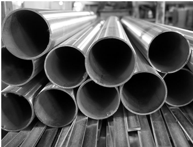
Ilustración 27: Tubos fabricados en Aluminio 6061. [40]
