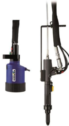
Ilustración 30: Remachadora con presión de multiplicador externo. (Fuente: Propia)
