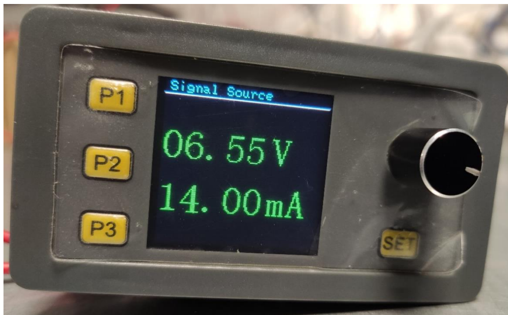
Figura 26: Imagen del componente que se utiliza como simulador de presión
