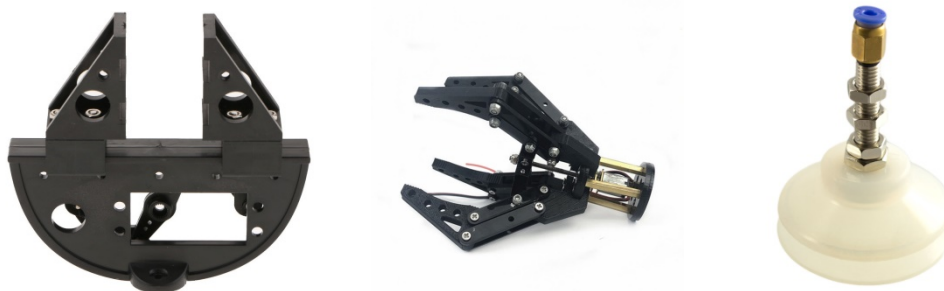
Imagen 4: Diferentes modelos de herramientas para coger objetos (garras 2 dedos, garras 4 dedos, ventosa)
