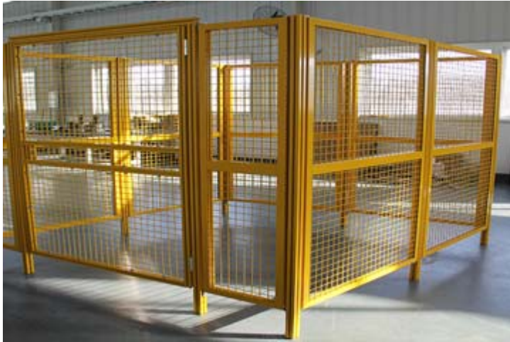
Imagen 6: Ejemplo de vallado de protección de la estación de empaquetado
