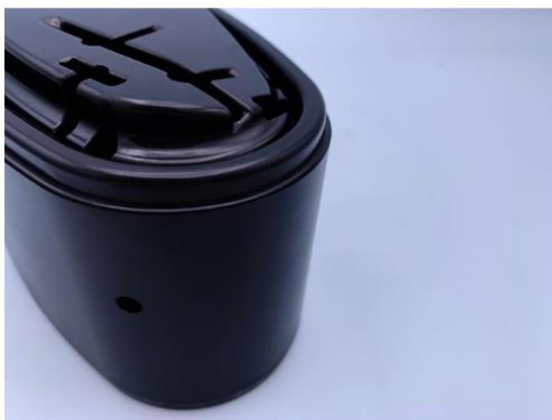
Figura 11: Ejemplos de aplicación de recubrimiento HiPIMS sobre piezas de matricería[17]
