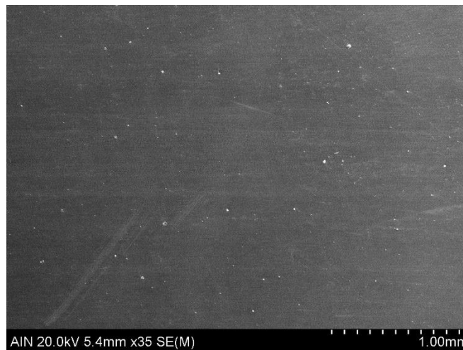
Figura 57: Imagen de la superficie recubierta mediante DLC obtenida mediante SEM en 35 aumentos
