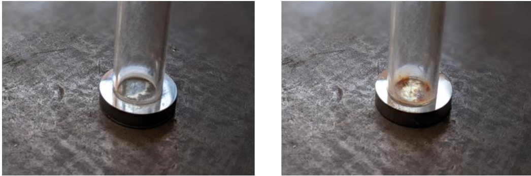
Figura 77: Vista de las dos probetas con sus tubos todavía adheridos M5 (izquierda) y M6 (derecha) tras sus respectivos ensayos
