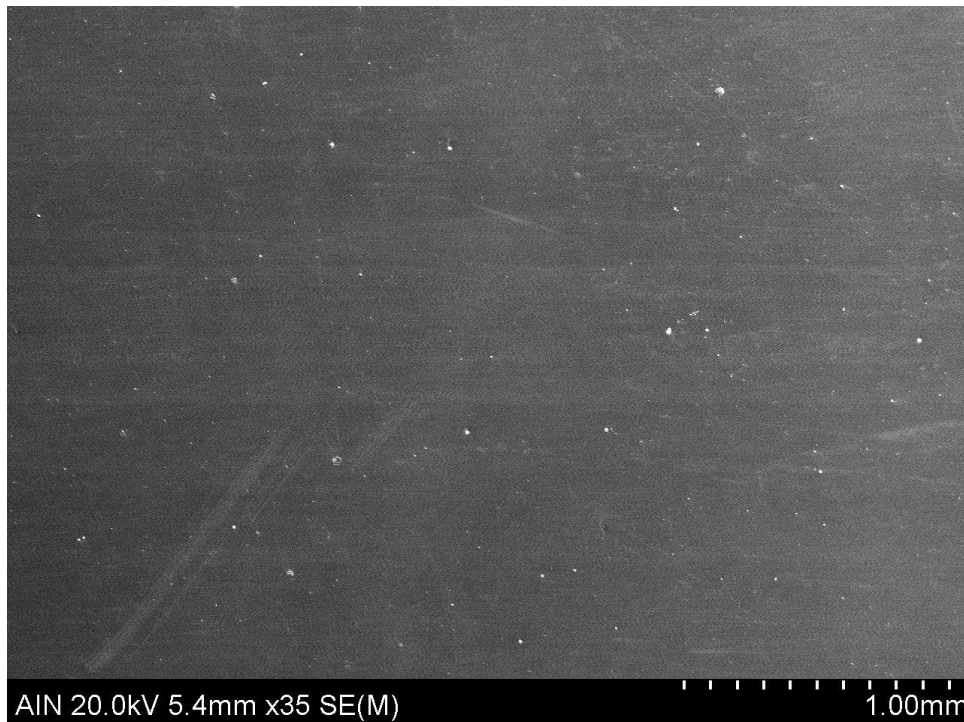
Figura 85: Vista de la superficie recubierta por DLC a:C en SEM a 35 aumentos
