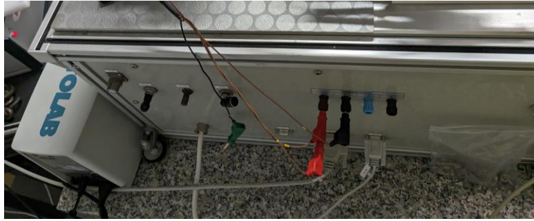
Figura 49: Conexión de las bananas en la parte trasera del equipo de ensayos
