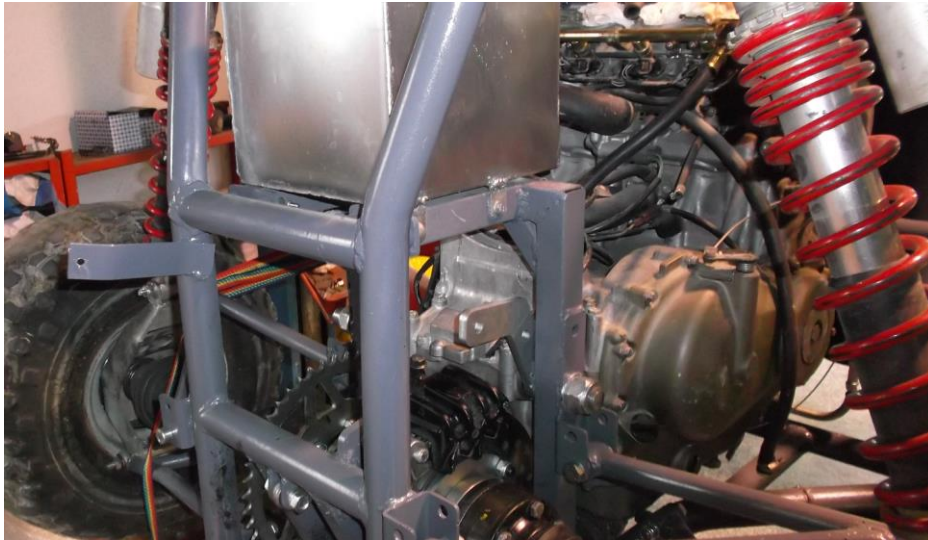
Ilustración 29. Motor colocado sobre chasis
