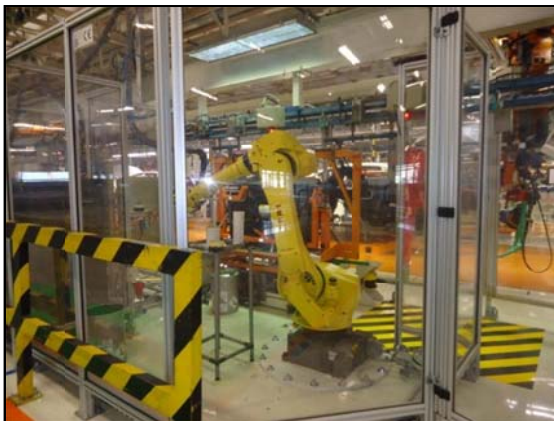
Imagen 2.7.4.2: Robot aplicación masilla
