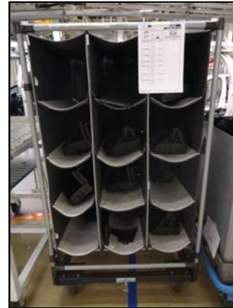
Imagen 2.6.2.6: Estantería secuenciada piezas para batería
