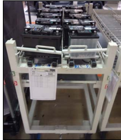
Imagen 2.6.2.8: Estantería secuenciada baterías
