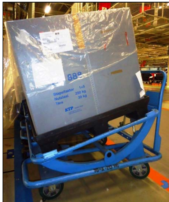
Imagen 2.7.3.4: GLT con inclinación para mejor suministro
