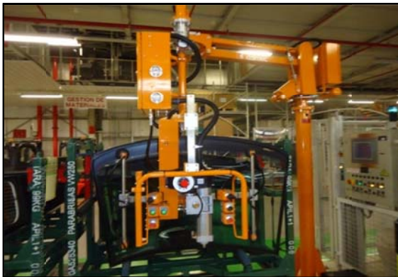
Imagen 2.7.4.4: Manipulador carga lunas en instalación
