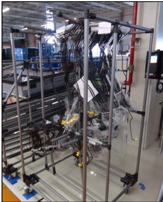
Imagen 2.6.1.17: Estantería mazos tuberías
