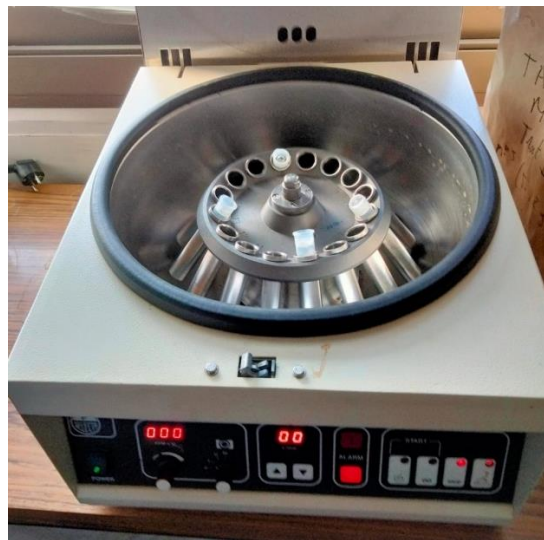
Fotografía 8: Centrifugadora utilizada para el ensayo.
