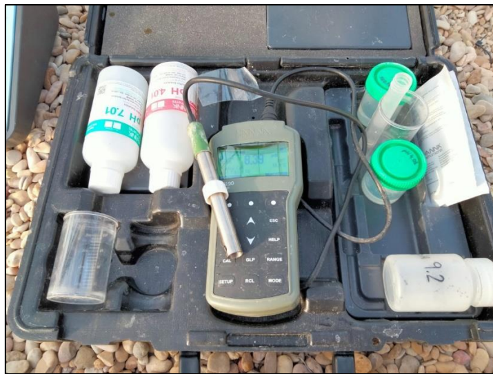
Fotografía 6: Peachímetro HANNA HI98190 utilizado en los muestreos.
