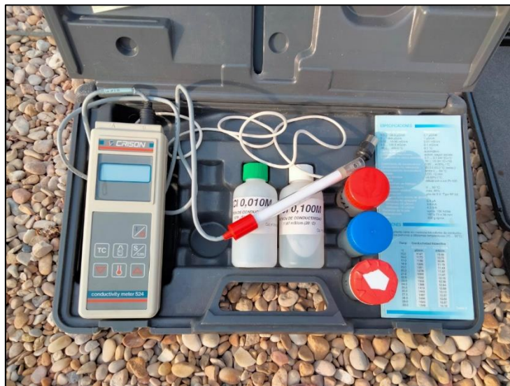
Fotografía 7: Conductímetro CRISON 524 utilizado en los muestreos.
