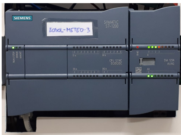
Figura 6.8 PLC de lectura y conversión de las variables meteorológicas de la microrred
