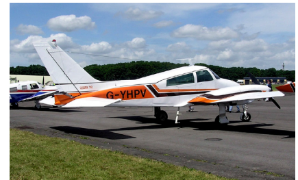
Figura C.7: Cessna 310N: 60 kWh por 100 pasajeros y km. Un Cessna 310 Turbo lleva a 6 pasajeros (incluyendo al piloto) a una velocidad de 370 km/h. Fotografía de Adrian Pingstone.
