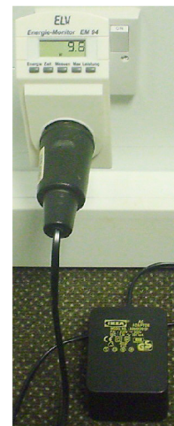
Figura 22.1: El pésimo adaptador AC de una lámpara de IKEA. ¡El adaptador usa casi 10 W, incluso cuando la lámpara está apagada!
