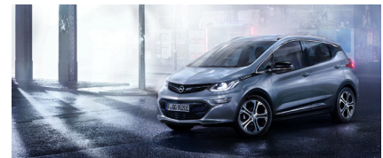
Figura 20.34: El Opel Ampera-e, claro competidor del Nissan LEAF. Tiene un consumo de 15,7 kWh a los 100 km pero una batería de 60 kWh. Foto de www.opel.es .
