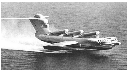
Figura C.16: Ekranoplano Lun. Un poco más largo y pesado que un Boeing 747. Fotografías de A. Belyaev.
