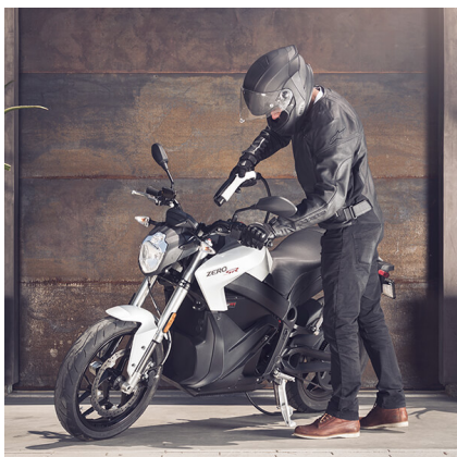
Figura 20.36: Esta motocicleta de gran potencia tiene un consumo de 7 kWh a los 100 km . Foto de www.zeromotorcycles.com .
