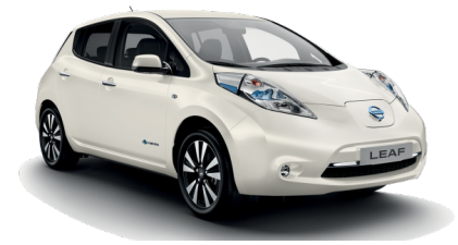
Figura 20.33: Uno de los vehículos eléctricos más vendidos en el mundo, el Nissan LEAF que tiene un consumo de 11,5 kWh a los 100 km y una autonomía que llega a los 400 km. Foto de www.nissan.es .
