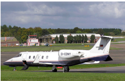
Figura C.8: Un Bombardier Learjet 60XR que transporta a 8 pasajeros a 780 \text{ km/h} tiene un coste energético de 150 kWh por 100 pasajeros-km . Fotografía de Adrian Pingstone.
