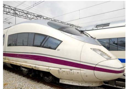
Figura 20.4: Este tren, a una velocidad de 140 km/h, consume aproximadamente 4 kWh por cada 100 pasajeros-km si viaja completamente lleno. Foto de RENFE.
