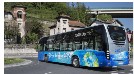
Figura 20.35: El autobús eléctrico de Irizar tiene un consumo de 170 kWh a los 100 km , y, gracias a unas baterías de 376 kWh, su autonomía asciende hasta los 250 km. Foto de www.irizar.com .
