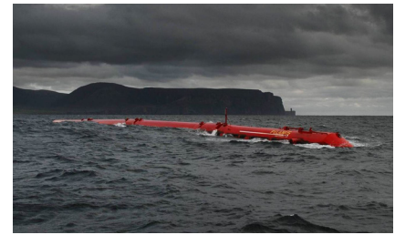
Figura 12.3: Un Pelamis es un dispositivo con forma de serpiente marina y dividido en cuatro partes, utilizado para absorber la energía de las olas. Se orienta encarando las olas que llegan. Las olas hacen que la serpiente se flexione y estos movimientos son soportados por generadores hidráulicos. El pico de potencia de una serpiente es de 750 kW. En la mejor localización del océano Atlántico cada serpiente propocionaría 300 kW de media.
