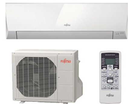
Figura 21.8: Aparatos interior y exterior de una bomba de calor aire-aire que tiene un coeficiente de operación de 4. Una de estas unidades Fujitsu puede entregar 3,6 kW de calor cuando emplea únicamente 0,845 kW de electricidad. También puede funcionar a la inversa, entregando 2,6 kW de frío cuando consume 0,655 kW eléctricos. Foto de Fujitsu.
