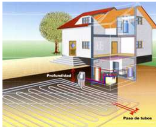
Captador en superficie.
