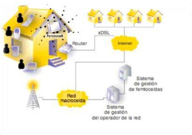
Figura 3.19. Esquema de una red femtocelular
