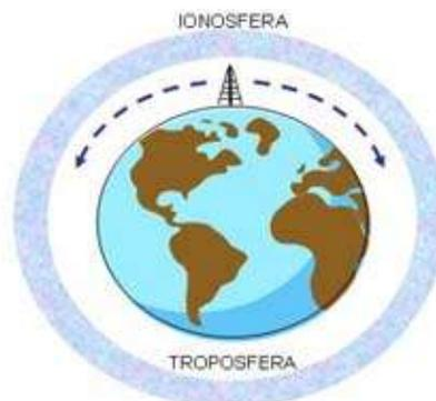
Figura 2.8: Propagación por onda de superficie
