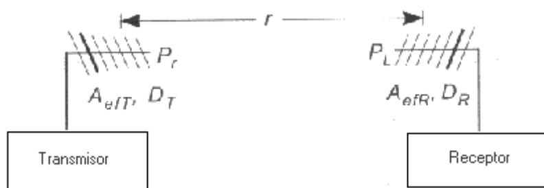
Figura 2.19. Balance de Potencia entre dos antenas
