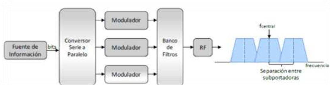
Figura 3.9: Transmisor basado en concepto multi-portadora
