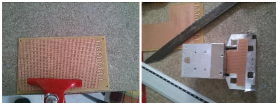
Figura 27.1: Recortar la placa de prototipado
