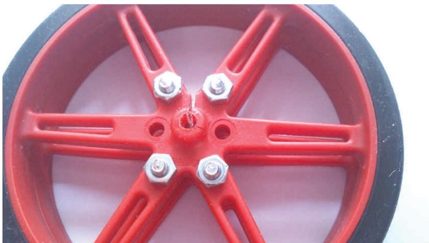
Figura 42.1: Fotografía de la rueda donde se aprecia el desgaste del buje
