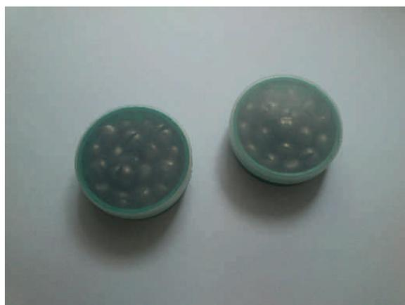
Figura 28.2: Plomos utilizados para aumentar el peso del robot
