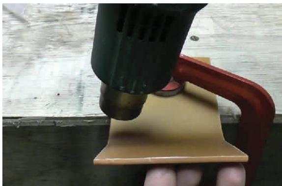
Figura 19.1: Doblado del plástico con una fuente de calor
