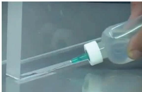
Figura 19.2: Pegado del plástico con cemento acrílico
