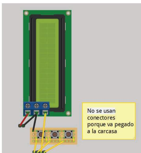
Figura 21.4: Esquema de la pantalla y los botones
