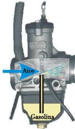
Pero la dosificación ha de cambiar según sean las condiciones de trabajo del motor, es decir, su régimen de giro y posición del acelerador. Para conseguirlo, en la actualidad existen dos tipos de carburadores:
