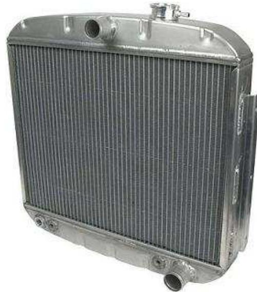
Los tanques, ya sean de plástico o de latón, cada uno tiene una conexión de manguera grande, una montada hacia la parte superior del radiador para permitir que el refrigerante salga y la otra montada en la parte inferior del radiador en el otro tanque para permitir que el líquido refrigerante retorne. En la parte superior del radiador debe existir una abertura adicional para la tapa del radiador o para adjuntar el vaso expansor.
