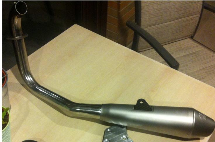
Si nos fijamos detenidamente, en este punto de la fabricación, el colector es de una longitud mayor a la diseñada, esto se realizó así, para que a la hora de encajar el sistema a la parte ciclo, podamos tener opción a alguna modificación para llevar a cabo el ajuste.
