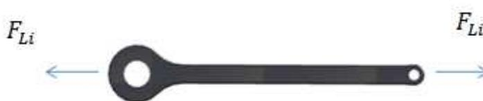
Figura 8-74 : Link sometido a tracción
