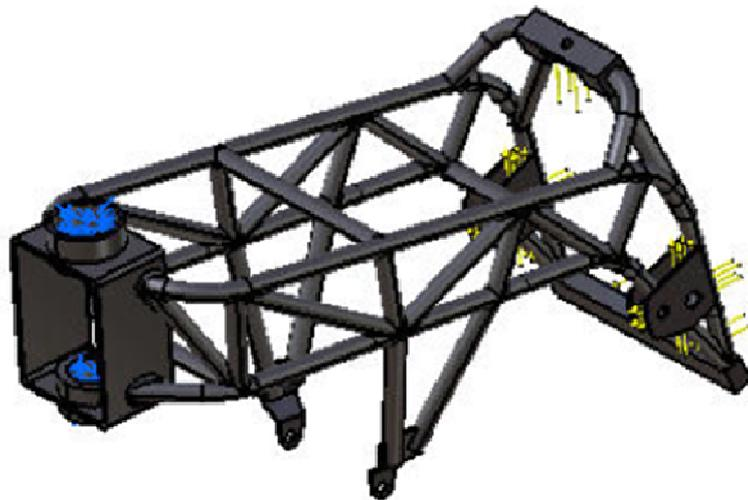
Figura 8-18 :Cargas y CC ensayo 3
