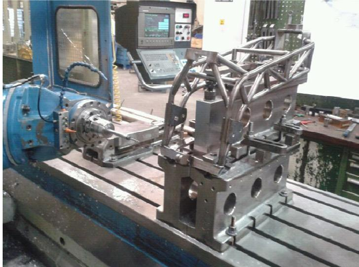
Figura 10-7 : Mecanizados de precisión en centro de mecanizado
