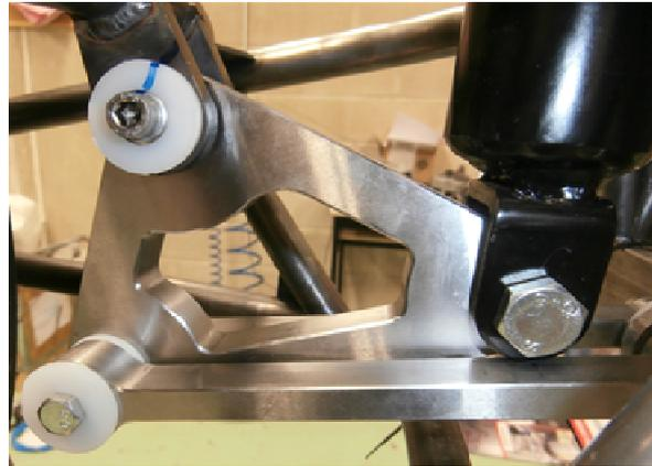
Figura 10-10 : Montaje suspensión trasera
