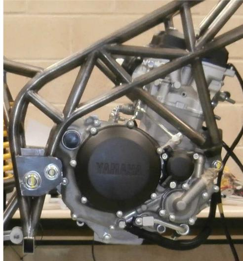
Figura 8.6-Motor anclado sobre el chasis.
