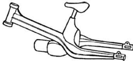
*Figura 4-11: Chasis no suspendido para un ciclomotor*
