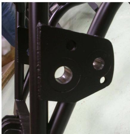
Figura 9-3 : Anclaje chasis-basculante.
