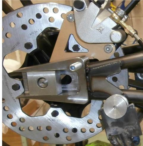
Figura 8.9-Anclaje del basculante al eje de la rueda trasera.
