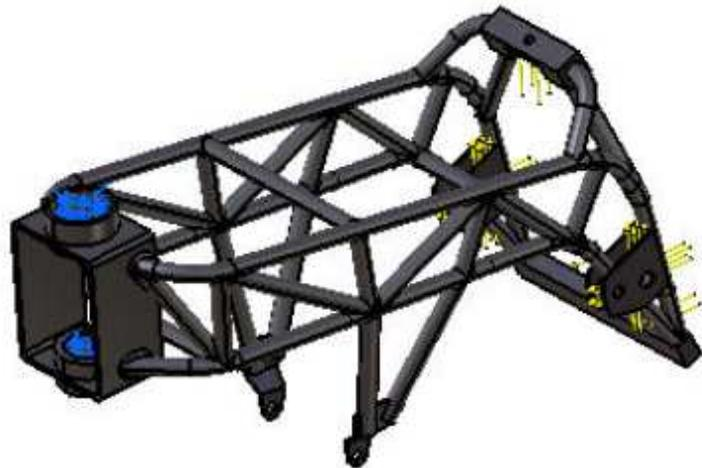
Figura 8-13 :Cargas y condiciones de contorno para el ensayo 2
