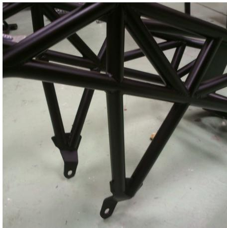
*Figura 8.5-Segundo anclaje motor-chasis: Tirantes.*
