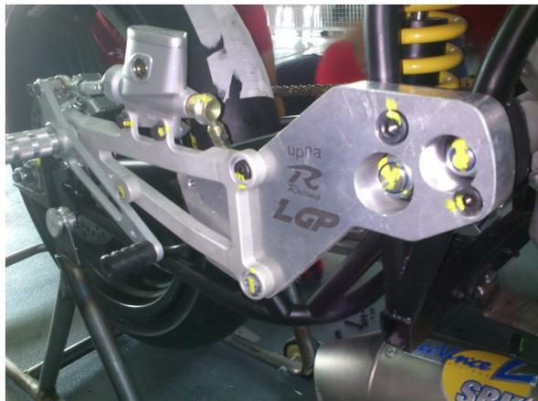
Figura 8.11-Anclajes de las estriberas.
