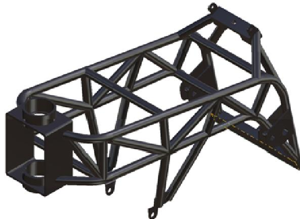
Figura 8-1 :Vista isométrica del diseño final del chasis.
