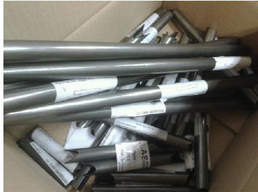
Figura 10-2 :Tubos cortados por láser
