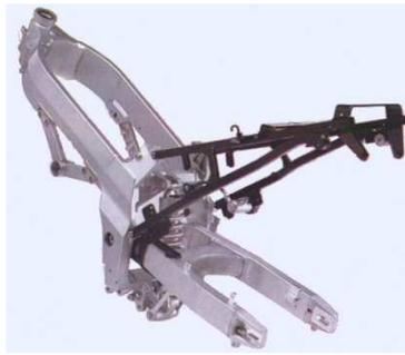
Figura 4-15 : Chasis doble viga.
