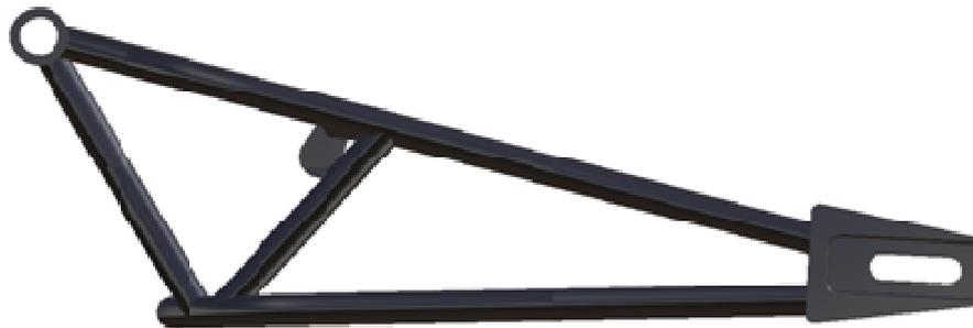
Figura 8-41 :Vista de perfil del diseño obtenido del basculante
