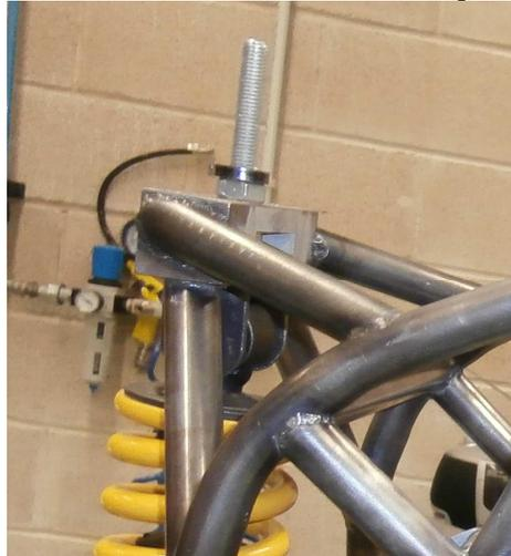
*Figura 8.10-Mecanismo de anclaje del amortiguador trasero.*
