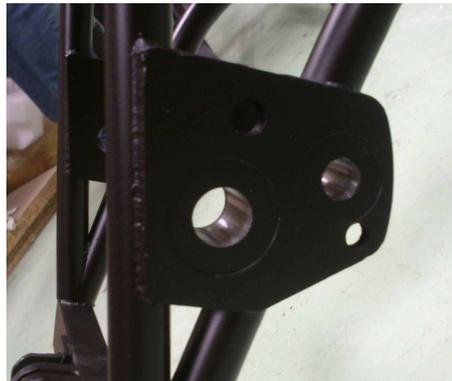
*Figura 8.1-Primer anclaje motor-chasis*
