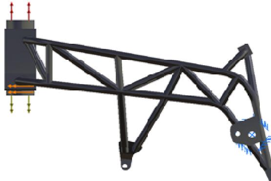
Figura 8-9 : Cargas y CC frenada máxima.
