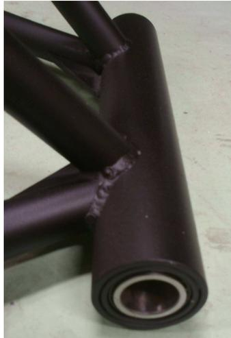
Figura 8.4-Anclaje del basculante
