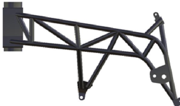
Figura 8-2 :Vista de perfil del diseño final del chasis
