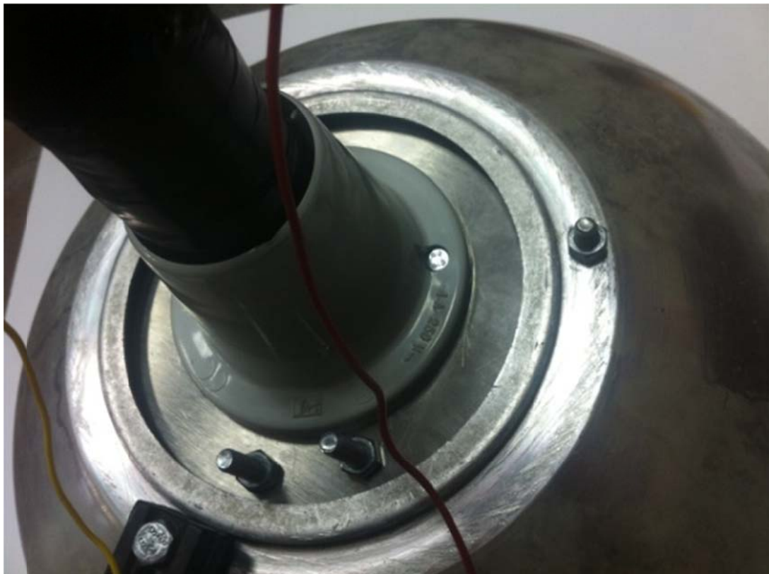
Foto 7. Piezas de sujeción del micrófono.
