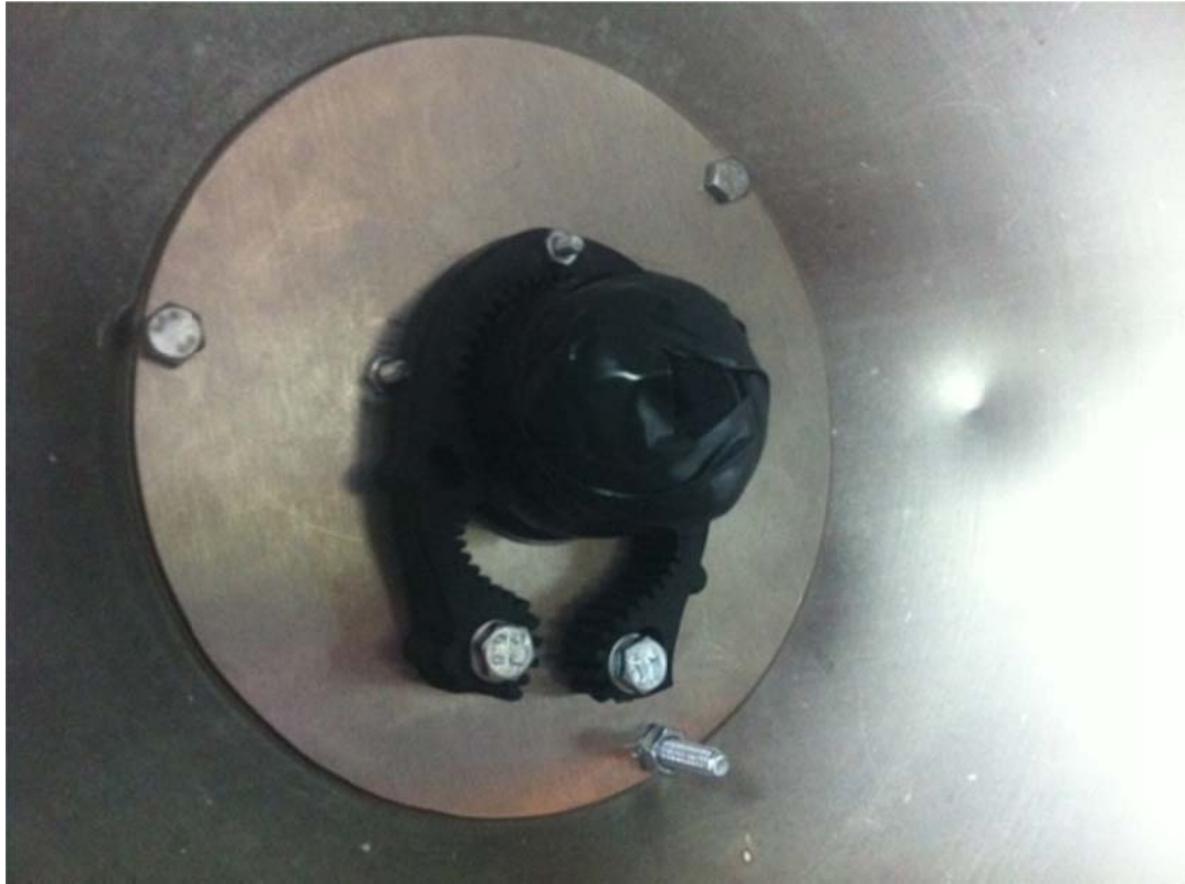
Foto 6. Sujeción del micrófono en el foco.
