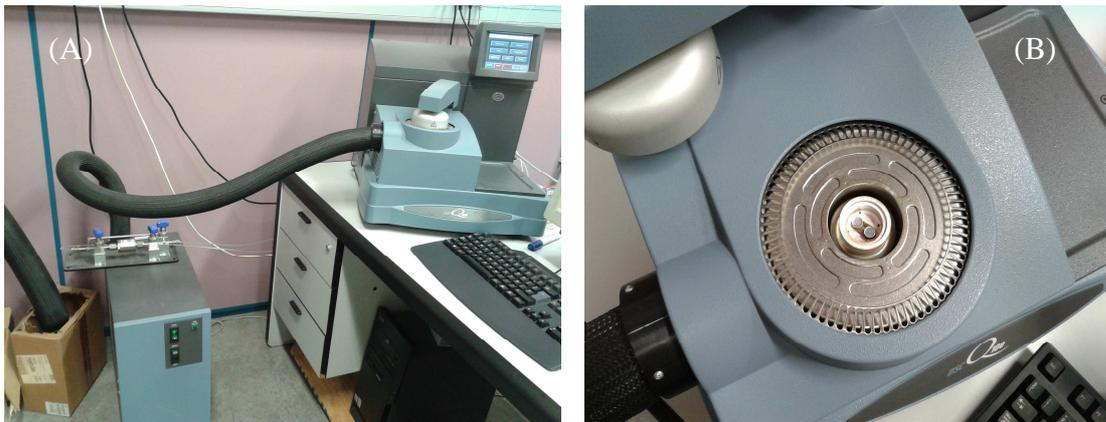
*Figura 2.8* Equipo DSC Q 100 (A) y detalle de los pans (B).
