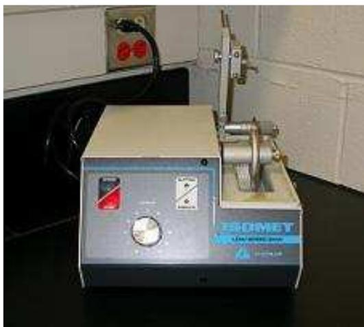
*Figura 2.1* Imagen de la sierra de disco utilizada durante la consecución del proyecto modelo Buehler isomet low speed saw.
