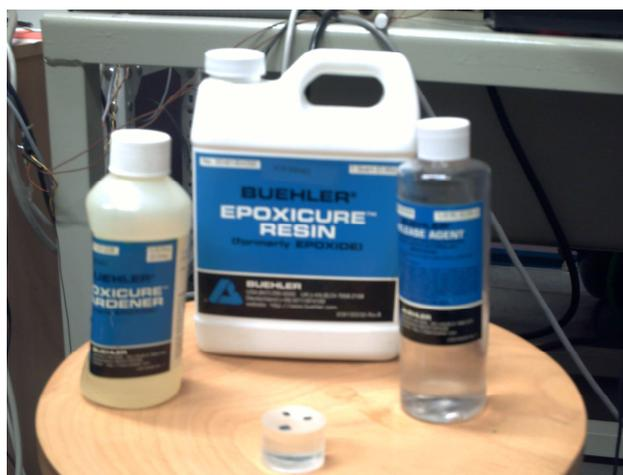
*Figura 2.2 Resina y endurecedor empleados para realizar el encapsulamiento.*
