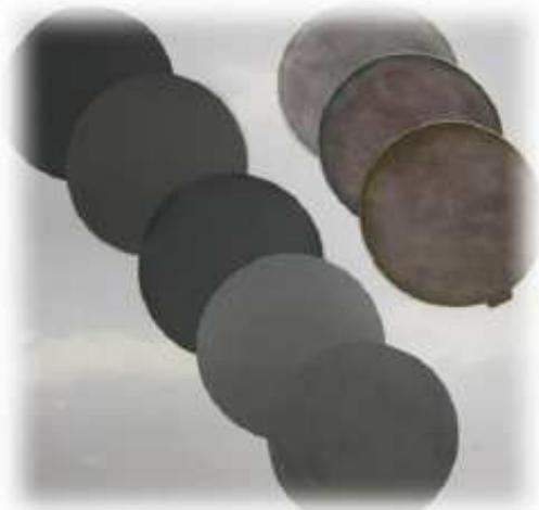
*Figura 2.3* Detalle de los paños utilizados para pulir la muestra en el proceso de preparación para el encapsamiento.
