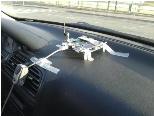
Fig. 3. Detalle de la antena transmisora en el interior del vehículo en el proceso realización de las medidas.
