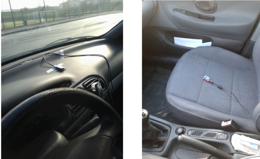
Figura 5.56 Posiciones de los sensores XbeePro para medidas de PER.
