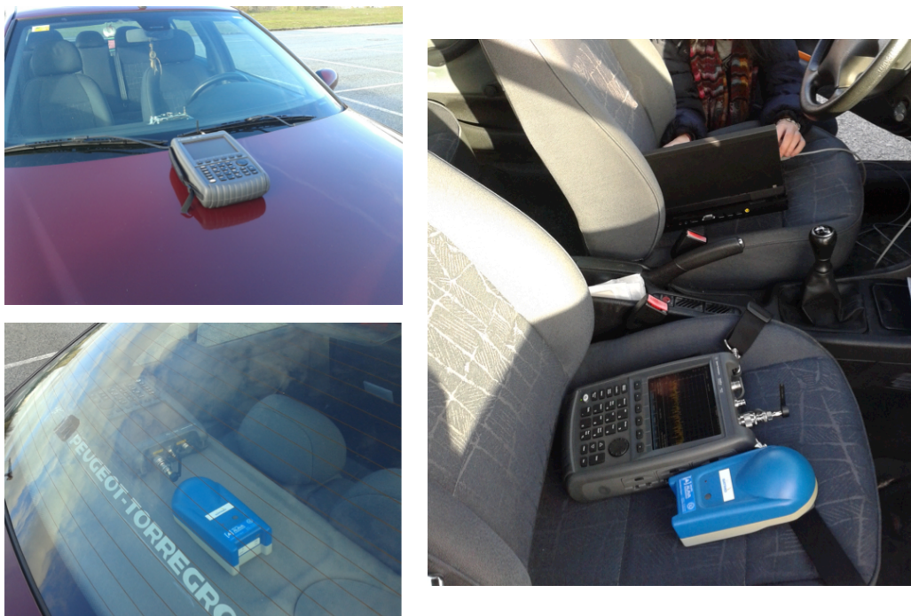
Figura 5.55 Diferentes posiciones de medida con el dosímetro y analizador de espectros.
