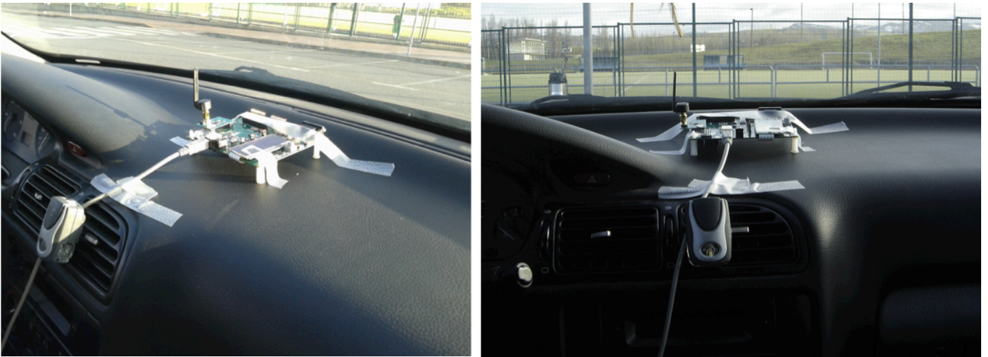
Figura 5.54 Posición de la antena Tx dentro del vehículo.
