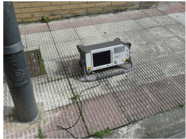
Figura 5.26 Generador de señal utilizado para medidas de RF.
