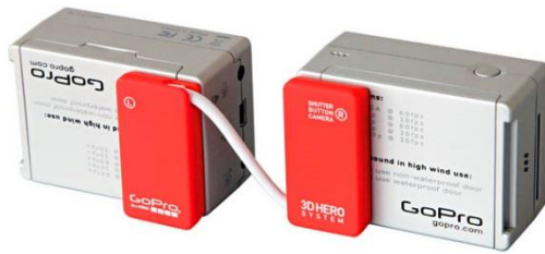
FIGURA 5.9 Dispositivo 3D Hero System sincronizando dos cámaras Go Pro.
