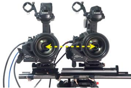
FIGURA 3.8 Distancia interaxial (en amarillo) entre dos cámaras.
