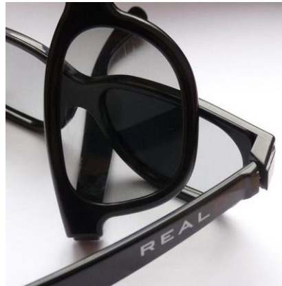
FIGURA 2.20 Dos pares de gafas RealD, demostrando el efecto de polarización.
