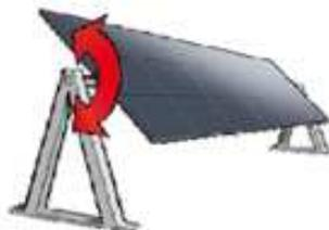
Figura 13. Seguidor de eje Polar
