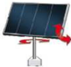
Figura 12. Seguidor de dos ejes
