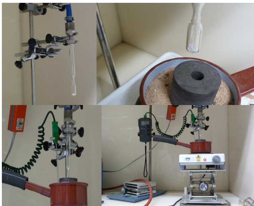
Figura 2.7. Tubo de vidrio acoplado al montaje de degasificación e introducido en el baño de arena con la sonda de temperatura
