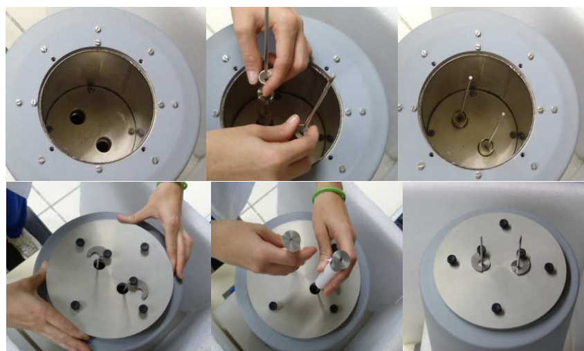
Figura 2.12. Introducción de las celdas y cerrado del calorímetro
