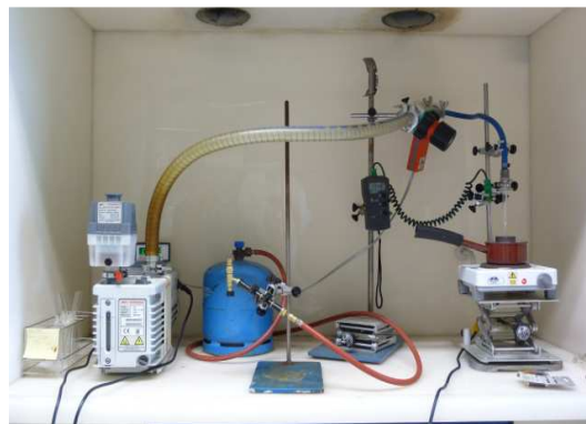
Figura 1. Montaje de desgasificación de las muestras
