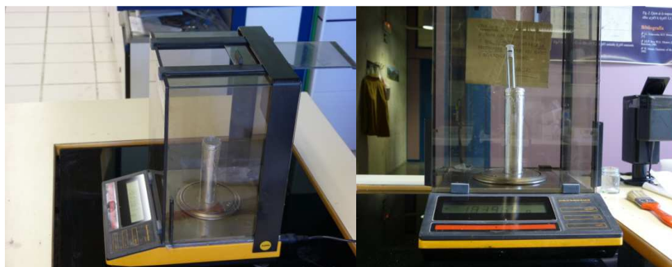
Figura 2.5. Balanza de precisión y dispositivo utilizado para pesar las muestras de xerogeles en los tubos de vidrio
