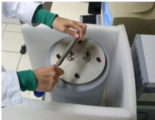
Figura 2.13. Experimento calorimétrico: rotura de la ampolla
