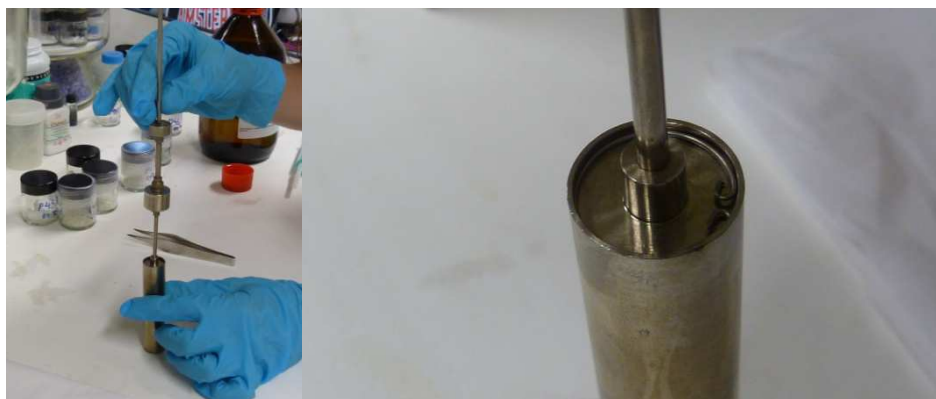
Figura 2.11. Cerrado de las celdas calorimétricas
