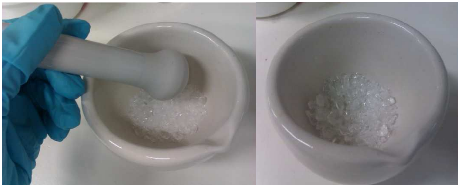
Figura 2.4. Trituración de las muestras de xerogeles híbridos monolíticos
