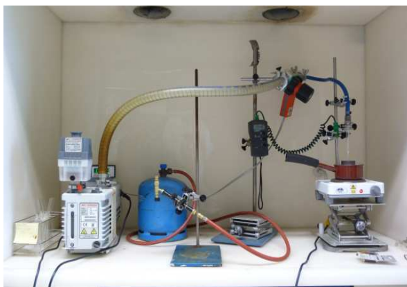
Figura 2.6. Sistema de degasificación de muestras
