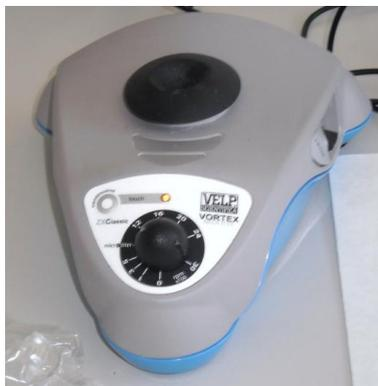
*Imagen 34. Agitador tipo vortex o mezclador de vórtice. (Fuente: elaboración propia).*
