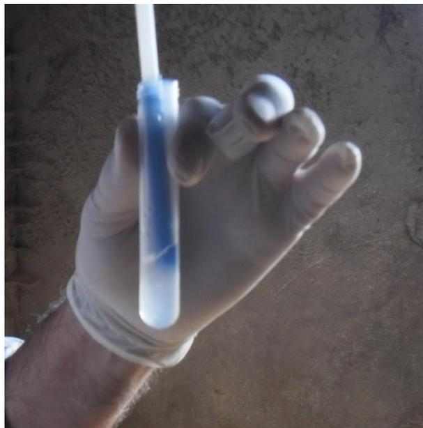
*Imagen 16. Lavado del raspador en el tubo con la solución de PBS. (Fuente: elaboración propia).*
