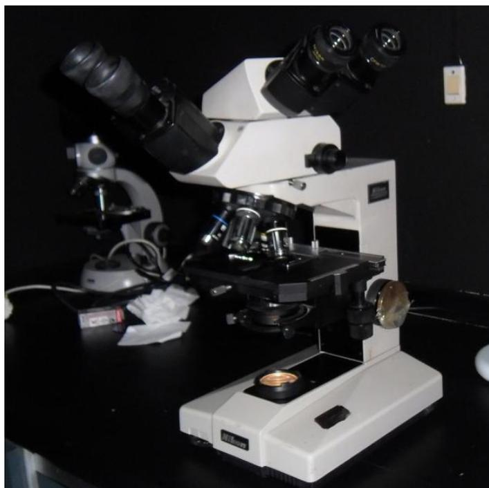
*Imagen 20. Microscopio con contraste de fases con el que son examinadas las muestras. (Fuente: elaboración propia).*
