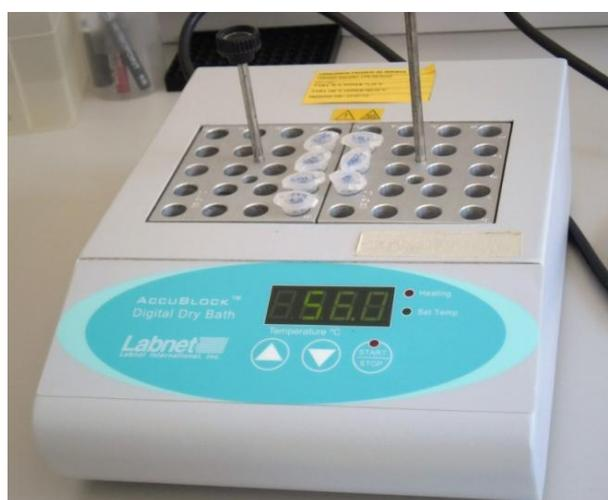
*Imagen 24. Una vez añadida la proteinasa K a la muestra, se mete a un termobloque para acelerar el proceso de lisis. (Fuente: elaboración propia).*
