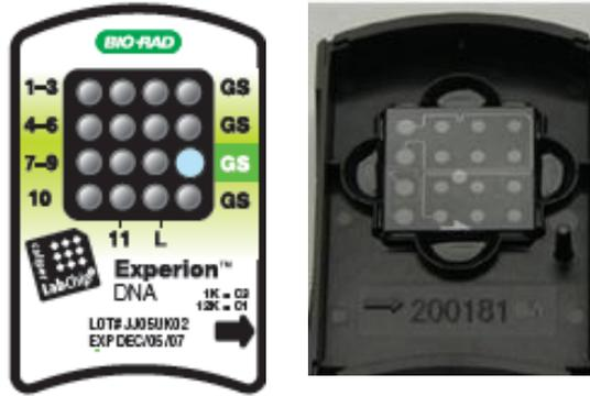
Imagen 28. El gel se añade en el pocillo coloreado de verde (derecha). Tras introducir el chip en la plataforma de cebado, el gel invade los microcanales (izquierda).
