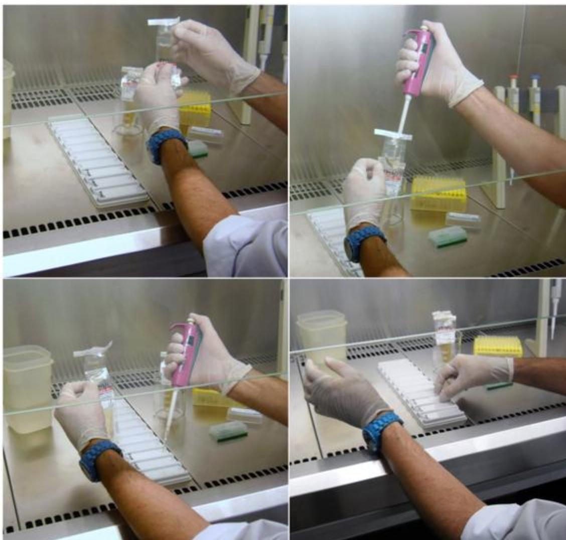
*Imagen 19. Preparación de las muestras para ser observadas al microscopio. De arriba a abajo y de izda. a dcha.: en el interior de una campana de flujo laminar, se homogeniza el contenido del sobre; se toman 30  $\mu\text{L}$  con una pipeta; se pasan a un portaobjetos y se cubren con un cubreobjetos. (Fuente: elaboración propia).*
