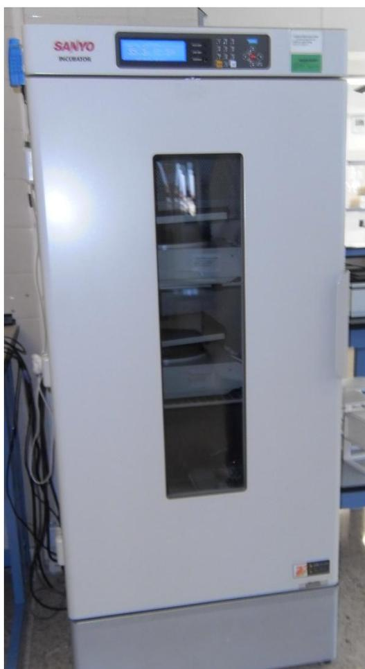
Imagen 18. Incubador en el que se mantienen las muestras a 37°C para el cultivo. (Fuente: elaboración propia).
