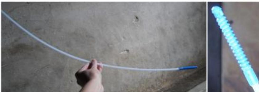
*Imagen32. Raspador de plástico (derecha) y detalle del extremo posterior en el que se aprecian las ranuras que hacen las veces de raspador (izquierda). (Fuente: elaboración propia).*
