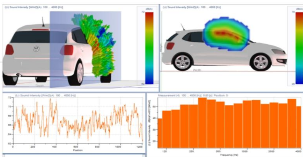
Figura 23: Informe de una prueba realizada con LMS Soundbrush
