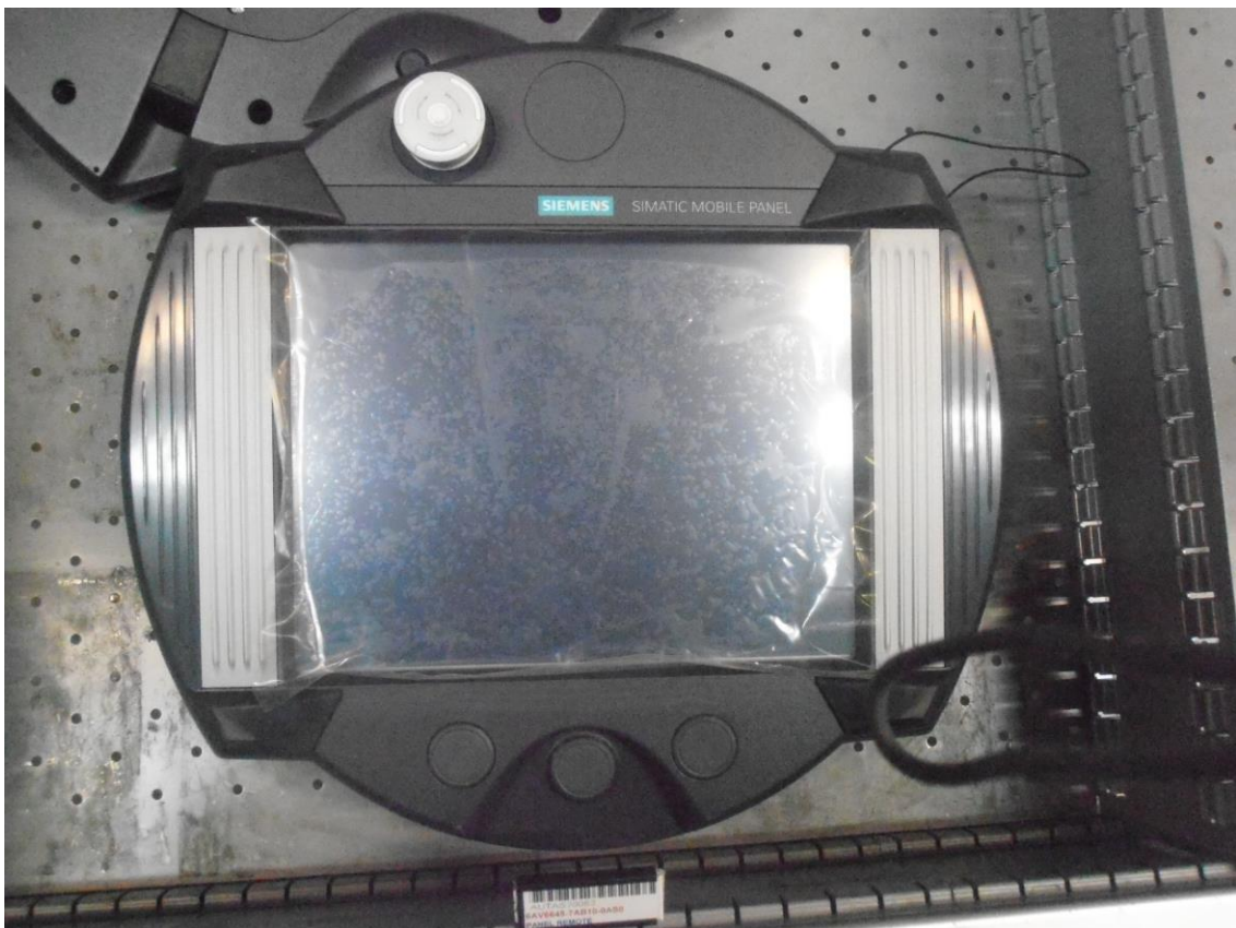
Foto de Panel operador SIEMENS MP377 PRO, que se incluirá en el GMAO
