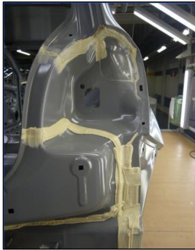
Ilustración 4. Aplicación de masilla en coche de serie. Ilustración 5. Aplicación de masilla coche de salón.
