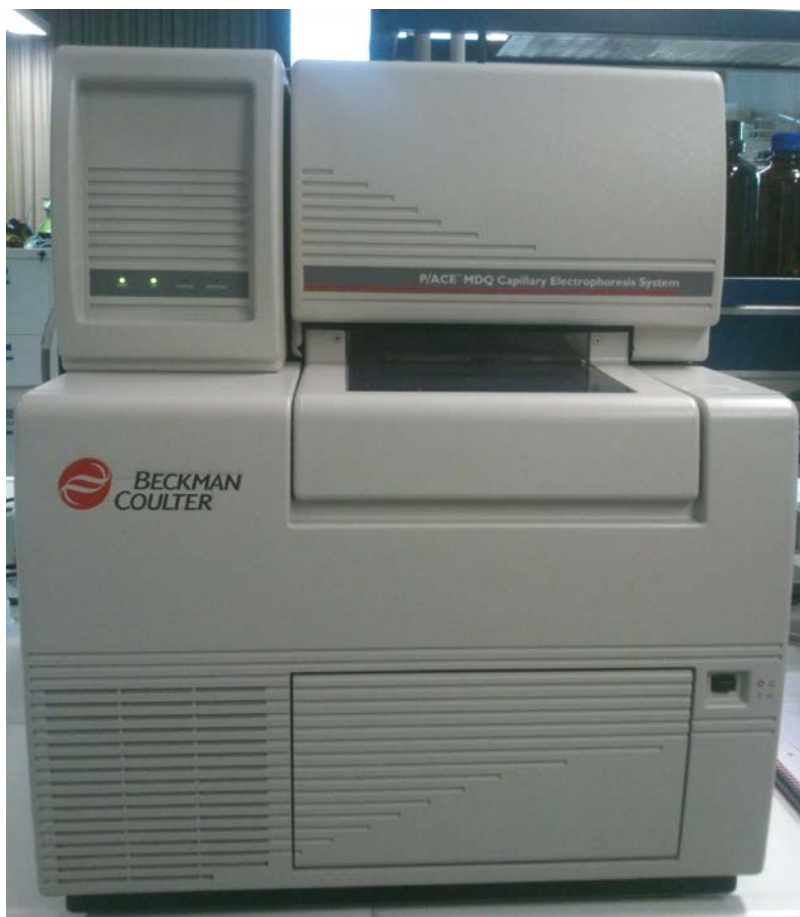
Figura 11: Medidor de electroforesis capilar Beckman Coulter PACE System 5500, con el que se realizaron las determinaciones de azúcares y almidón.
