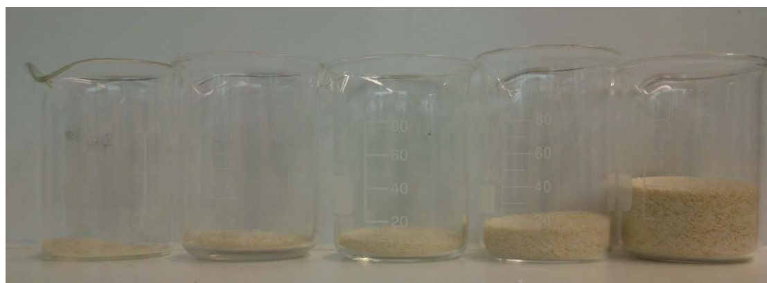
Figura 6: Contenido de agar por 100 ml de los 3 tratamientos utilizados y de dos con los que no se consiguieron resultados funcionales. Empezando por la izquierda se observa la cantidad creciente de agar utilizada para los tratamientos de 1,5%, 3% y 5% y los dos experimentales de 12,5% y 25% que resultaron irrealizables.
