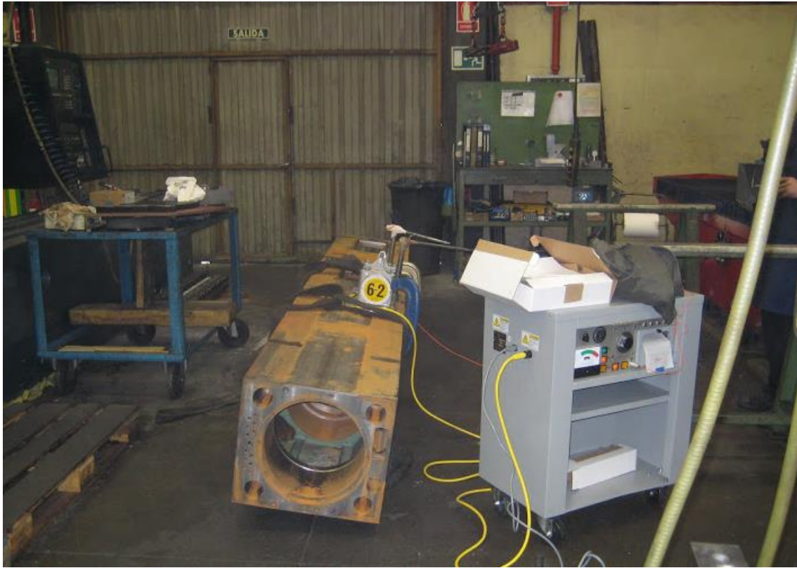
Ilustración 58: Aplicación de vibración a un carnero de máquina herramienta
