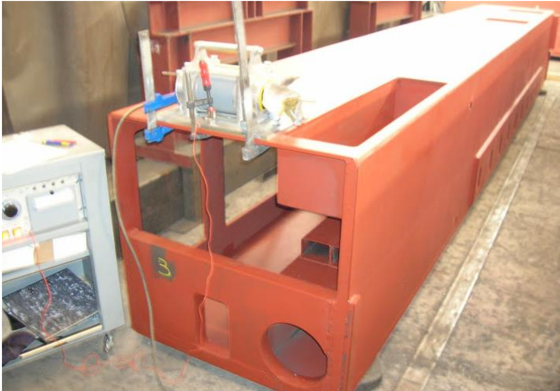
Ilustración 59: Aplicación de vibración antes del proceso de mecanizado
