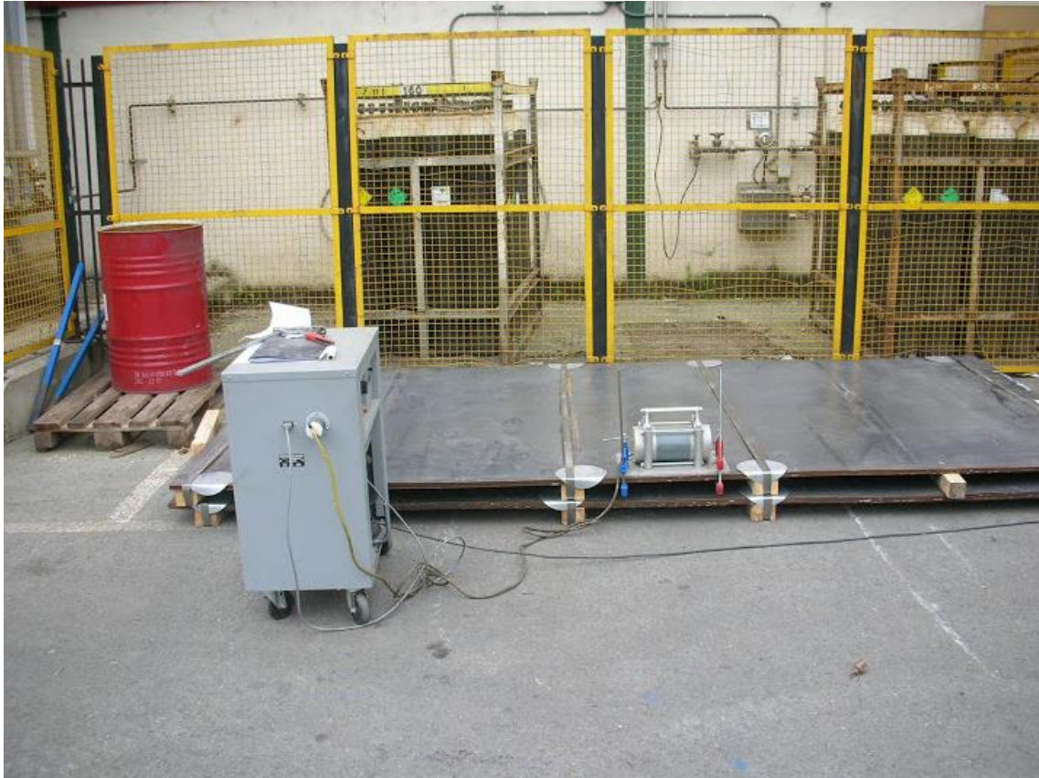
Ilustración 55: Aplicación de vibración a la materia prima previo a su procesamiento
