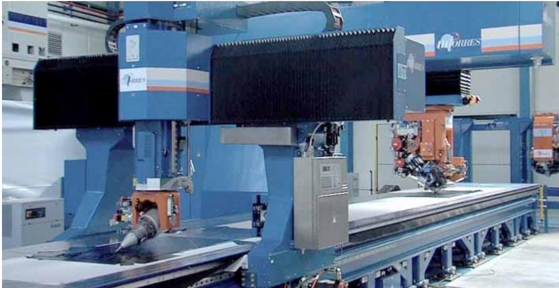
Ilustración 67: Máquina de aplicación de fibra de carbono y corte mediante ultrasonidos
