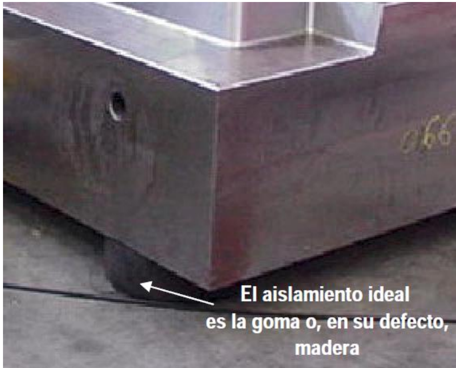
Ilustración 53: Aislamiento del suelo con goma como requisito para vibrar la pieza
