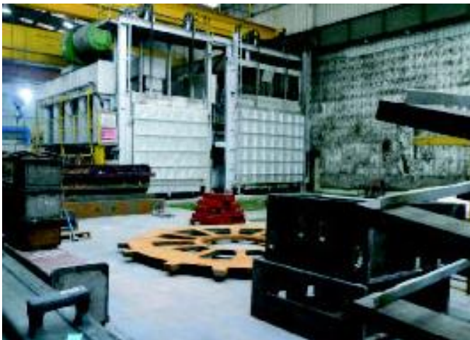
Ilustración 36: Hornos para tratamiento térmico
