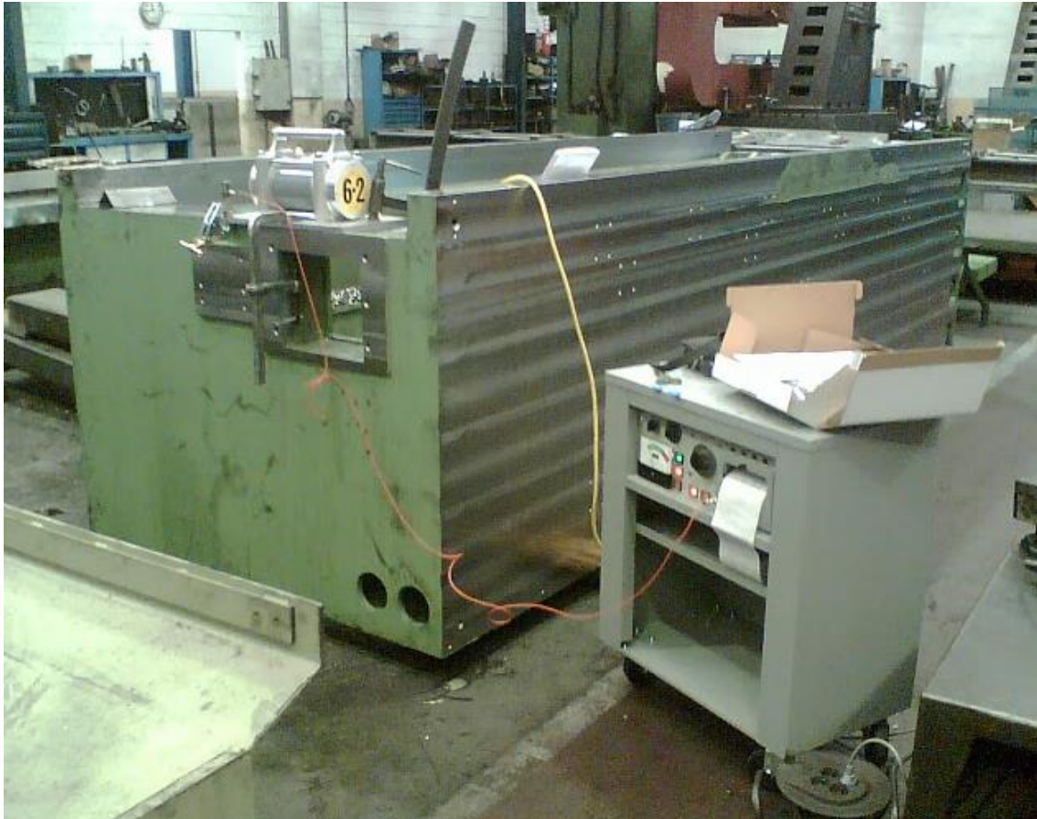
Ilustración 56: Aplicación de vibración tras el mecanizado de desbaste y previo al mecanizado de acabado
