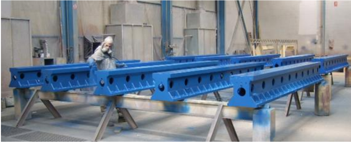
Ilustración 45: Proceso de aplicación de pintura
