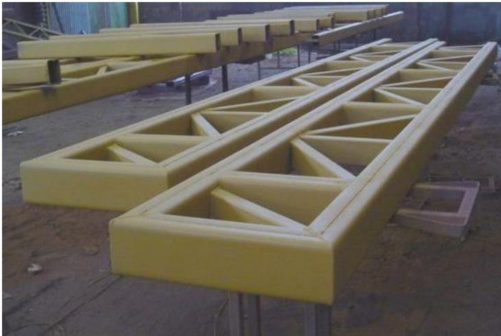
Ilustración 40: Celosías de acero
