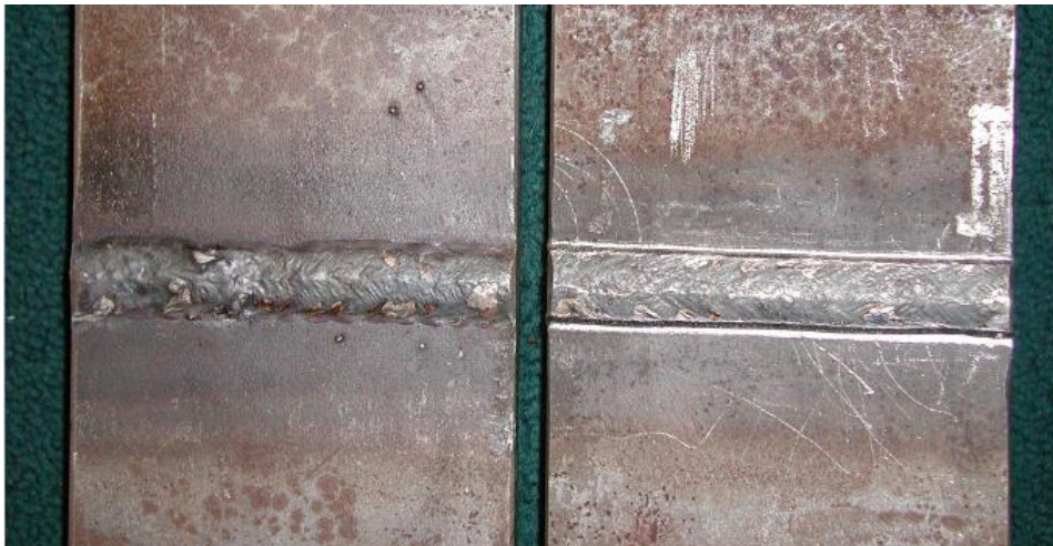
Ilustración 32: Efecto del needle peening sobre el cordón de soldadura
