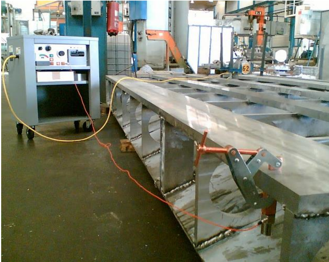
Ilustración 60: Aplicación de vibración a una estructura soldada de aluminio
