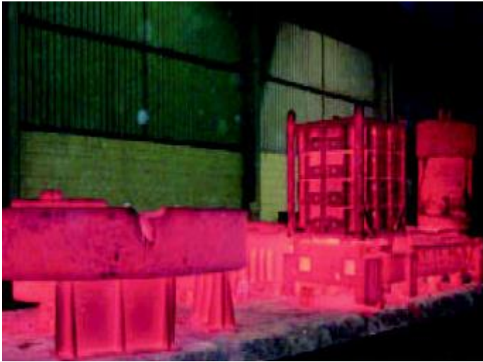
Ilustración 37: Piezas tras el tratamiento térmico
