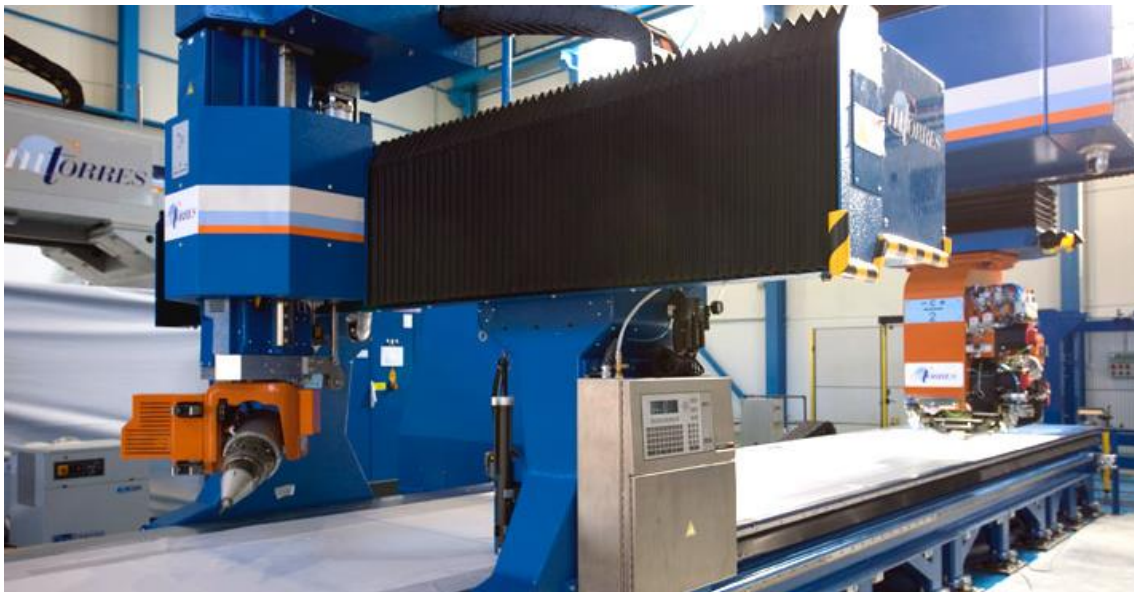
Ilustración 66: Máquina de aplicación de fibra de carbono y corte mediante ultrasonidos
