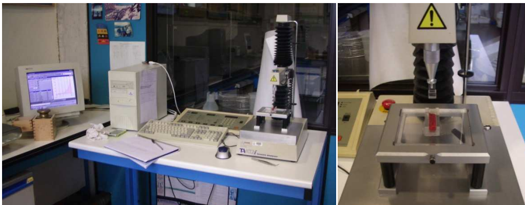
Figura 20. Texturómetro Texture Analyzer TA-XT2i (Stable Micro System, Reino Unido) (izquierda) y detalle de la sonda Lepetit empleada (derecha).
