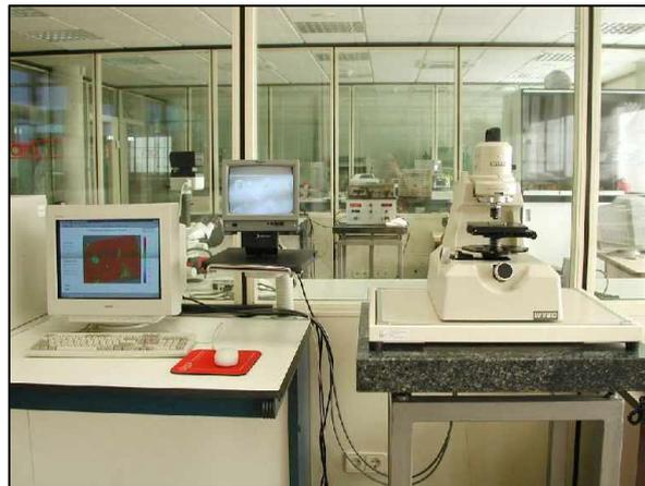
**Figura 4.8.** Equipo de perfilometría interferométrica en AIN.
