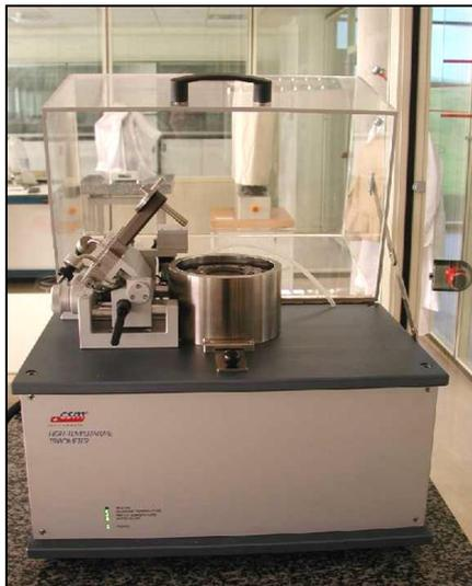
**Figura 4.9.** Tribómetro CSM THT utilizados en la evaluación del coeficiente de fricción y de desgaste.
