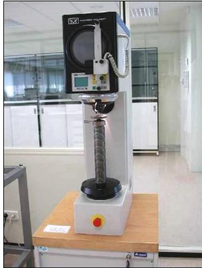
**Figura 4.2.** Durómetro multiescala en AIN empleado para las medidas de HRc.
