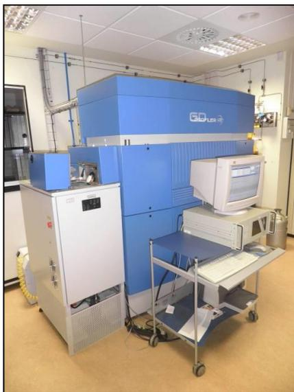
**Figura 4.1.** Espectrómetro GDOES en AIN.
