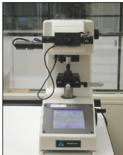
**Figura 4.4.** Microdurómetro BUEHLER en AIN para las medidas de microdureza.
