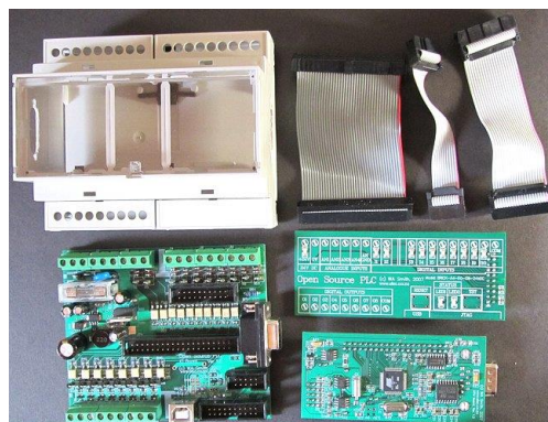
Figura 16 Todos los componentes constituyentes de un Open Source PLC.
