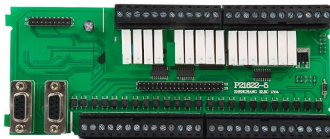
Figura 83 Ejemplo de diseño nivel 2. Conectores y aislamiento.
