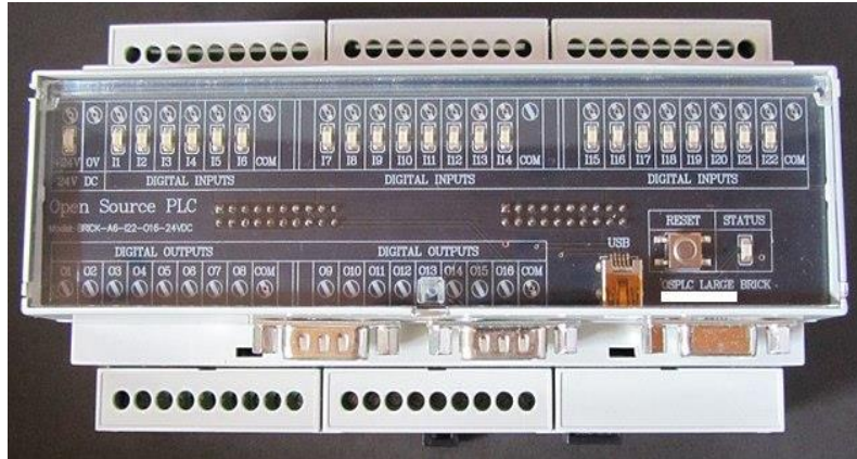
Figura 17 Open Source PLC versión ampliada con un número aumentado de entradas y salidas, así como mayor potencia que su versión inferior.
