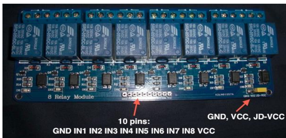
Figura 37 Detalle de la PCB con 8 relés.
