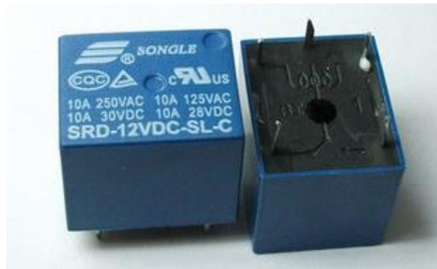
Figura 97 Relé SRD-5VDC-SL-C usado en los relés.
