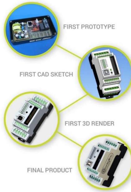
Figura 11 Ejemplo de evolución del prototipo de un PLC de hardware libre. En este caso de Controllino.
