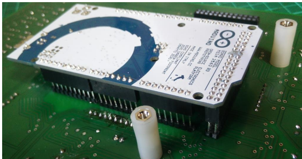
Figura 58 Montaje final del Arduino Mega 2560.
