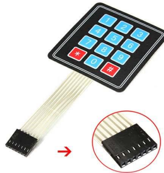
Figura 25 Keypad de membrana flexible de 12 posiciones usado en el proyecto.
