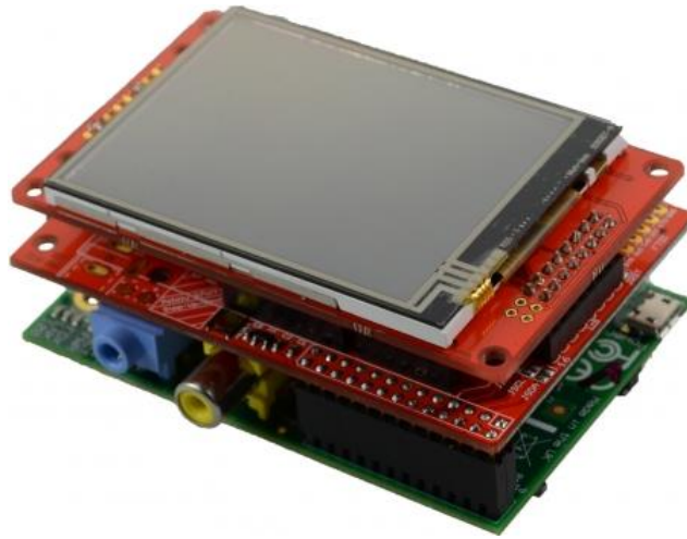
Figura 6 Ejemplo de acople de Shield acoplables a una Raspberry PI B+
