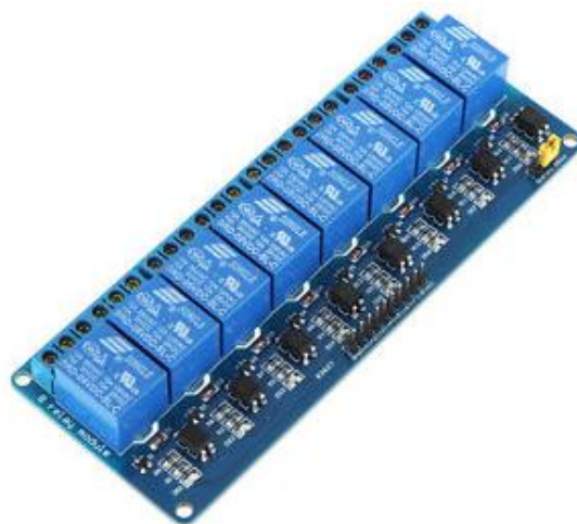
Figura 26 PCB adicional de 8 relés para el control de cargas.
