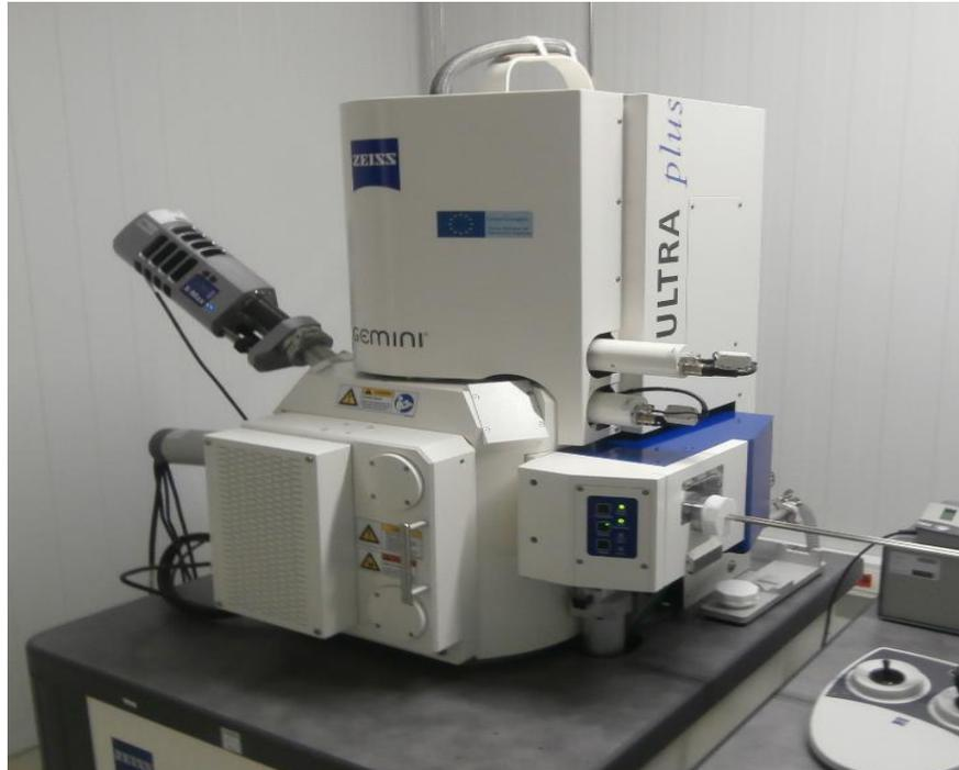
*Figura 15: Imagen del Microscopio Electrónico de Barrido ULTRA plus 8.170 empleado en el análisis de las muestras.*
