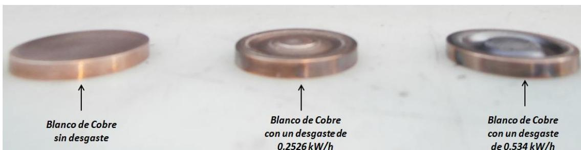
Figura 33: Comparación del desgaste de los blancos. Los blancos tienen 25,4 mm de diámetro y 3,18 mm de espesor.
