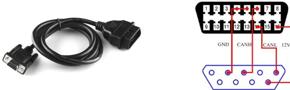
Figura 4.7. Cable OBD2-DB9 y conexionado de pines [17]
