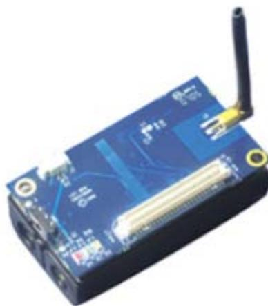
*Figura 2: Foto de una mota XM2110-IRIS con una antena estándar.*
