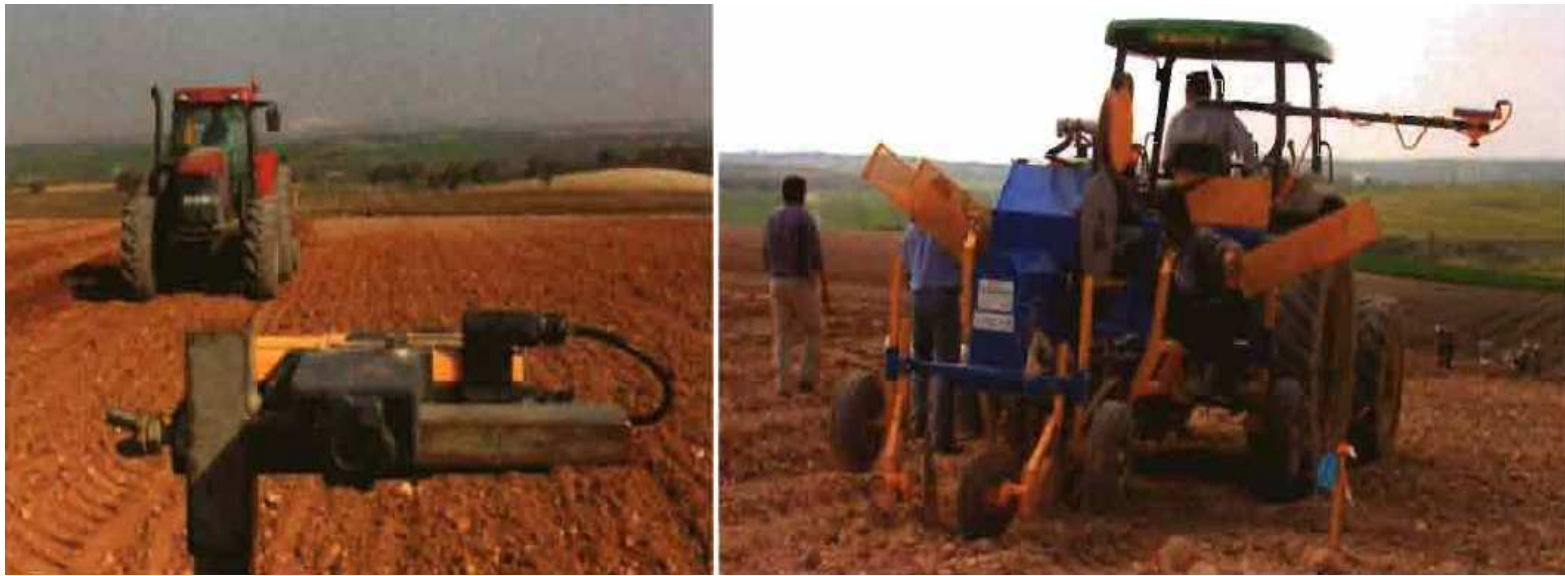
Foto6: Plantadora con guiado laser
