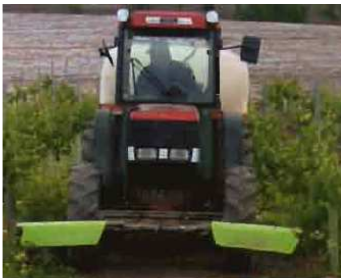
Foto 13. Barra pulverizadora con pantalla a deriva
