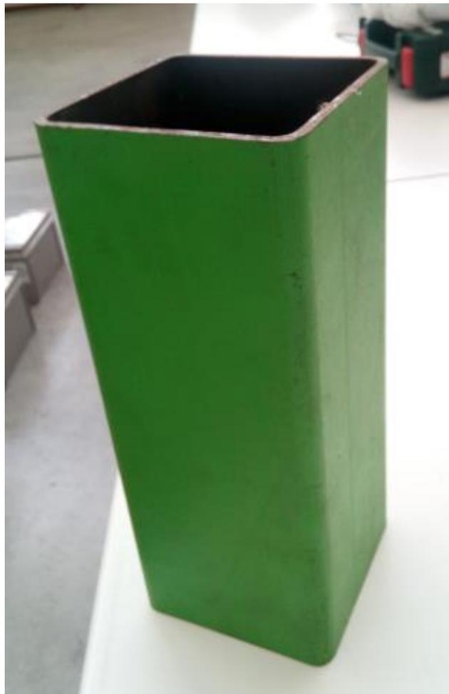
Ilustración 37. Perfil cuadrado que se usará para construir la estructura. Fuente: Edificio Talleres UPNA.
