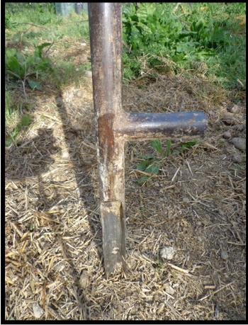
Figura 11. Herramienta utilizada para la recogida de muestras del suelo. Esta herramienta se introduce en el suelo se gira 180° ya al sacarla del suelo (figura12) obtenemos un cilindro de tierra de unos 30cm que cogemos para analizar en laboratorio (figura 13)
