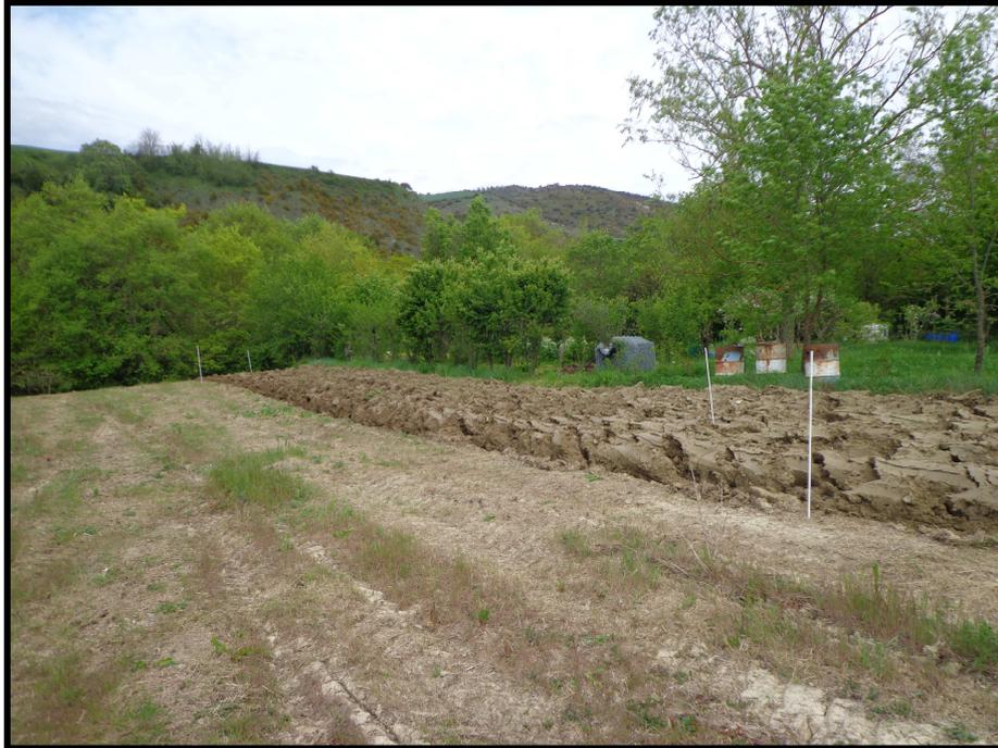
Figura 22. Detalle del ensayo de resbalamiento en el que se aprecian las varillas para marcar el comienzo y fin del número de vueltas, para su posterior medición con la cinta métrica. Los resultados obtenidos los analizaremos en la parte de resultados y discusión.
