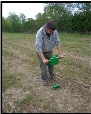
Figura 9. Introducción de la varilla con punta cónica en el suelo a velocidad constante.
