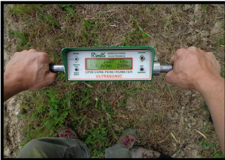
FIGURA 8. Pantalla en la que se observa la profundidad a la que está trabajando, la presión en ese punto y la velocidad de penetración.
