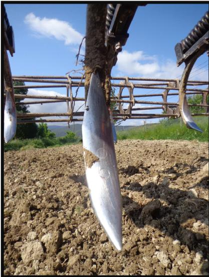
Figura 5. Detalle de la reja del chisel encargada de penetrar en el suelo y romper la estructura de forma vertical.
