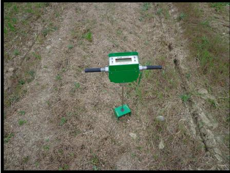
FIGURA 7. Detalle penetrometro Rimik.
