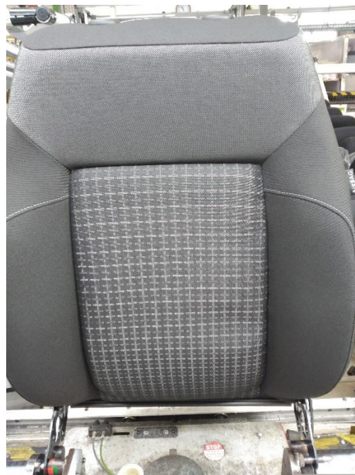
ENVARILLADO SIN CERRAR PERFIL
