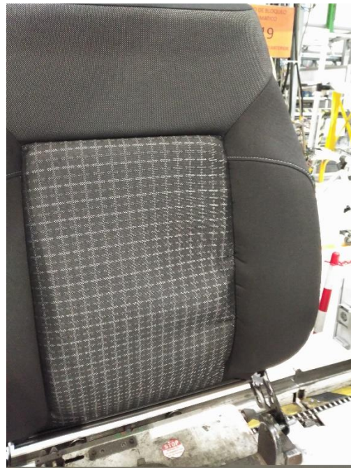
ENVARILLADO SIN CERRAR PERFIL
