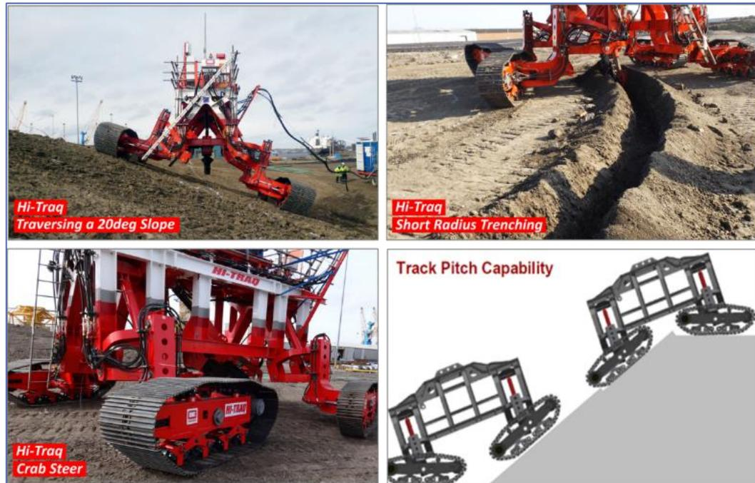
Figura 5-1: Vehículo Hi-TRAQ con cuatro cadenas para enterramientos de cable submarinos [17]
