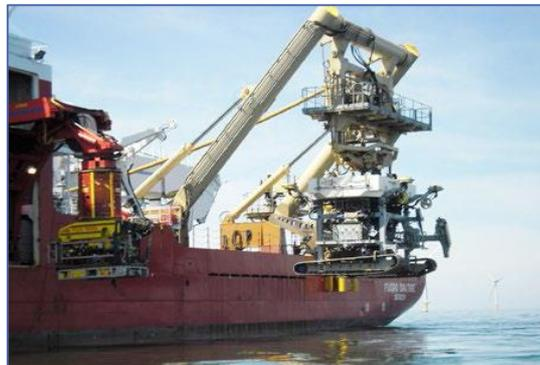
Ilustración 5-4: Fugro Q1400 excavadora de zanjas [19]
