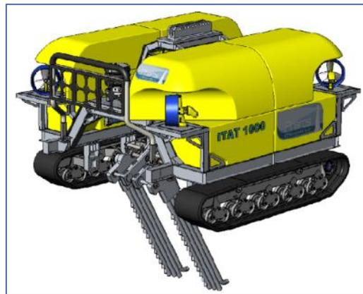
Ilustración 5-3: Vehículo autónomo ITAT 1000 de excavar zanjas de Pharos Offshore Group [18]
