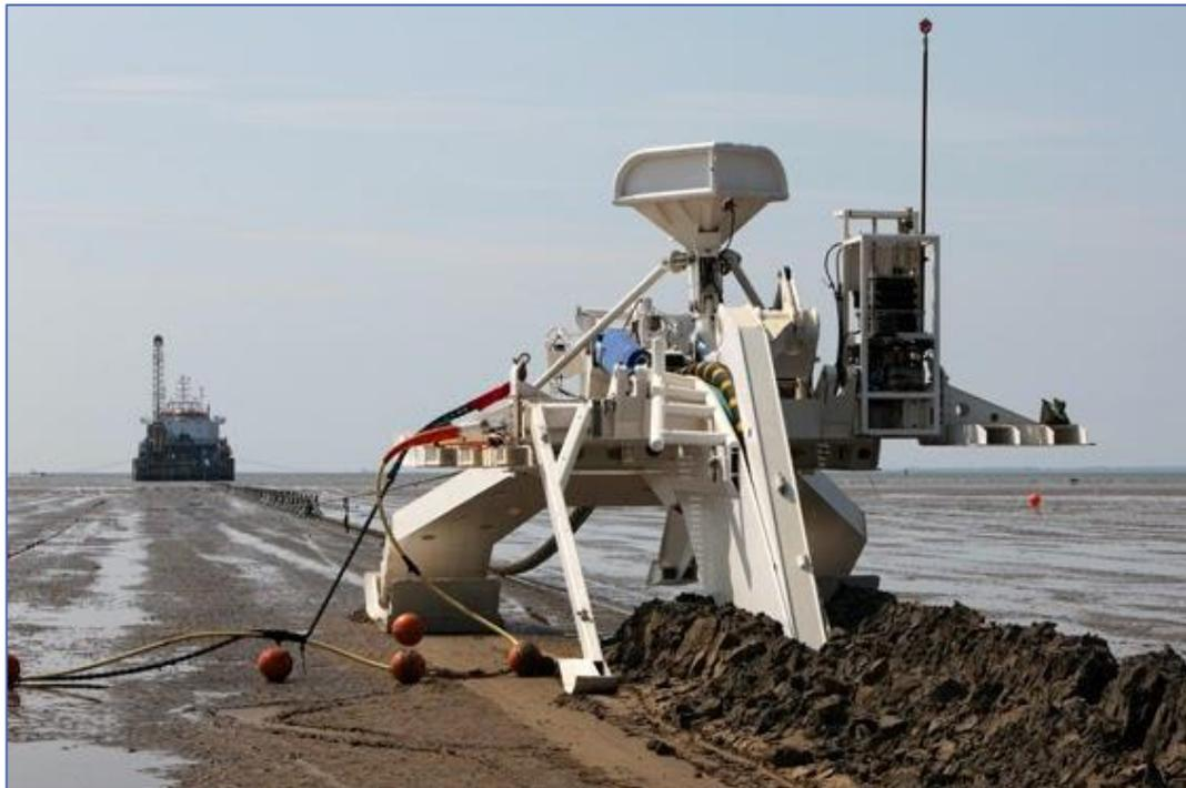
Ilustración 2-2: Arado para el enterramiento de cables submarinos [7]
