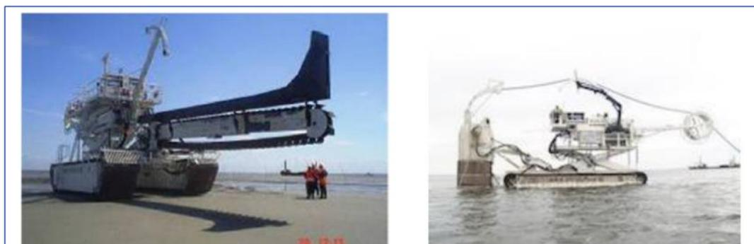
Figura 5-6: Ejemplos de unos vehículos para excavar zanjas para la colocación de cables submarinos [20]
