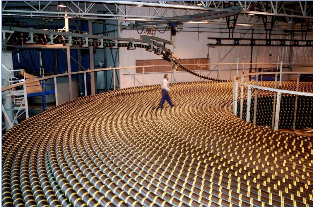
Ilustración 2-4: Carrusel para el almacenamiento de cables de potencia [9]
