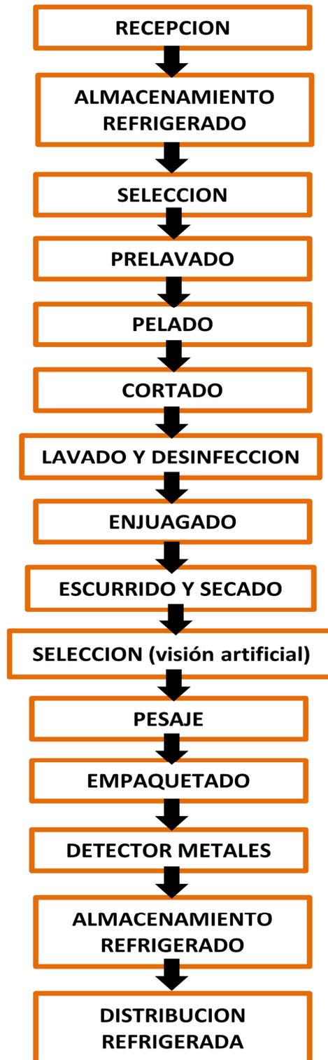
**Figura 3: Diagrama de proceso de patata fresca**
