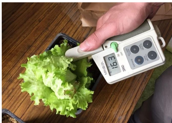
Figura 8. Medición de intensidad de coloración con el aparato SPAD-502. Obsérvese que la planta está ligeramente arrepollada.
