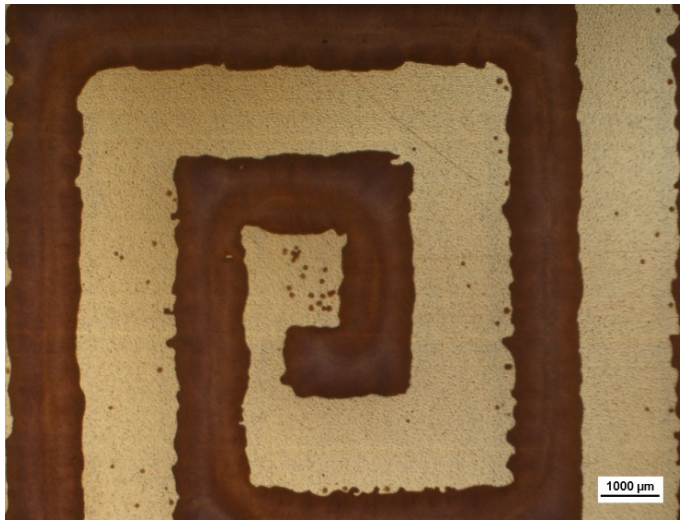
Figura 6.9. Resultado de la impresión de la Tinta Zr/BaTi_30 sobre Kapton®.
