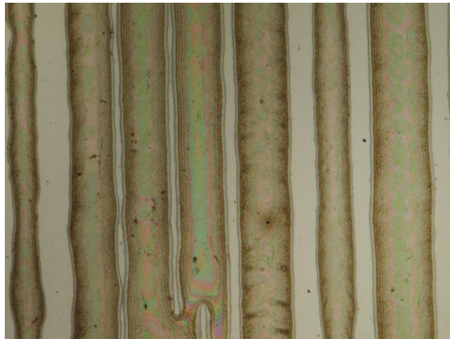
Figura 3.48. Detalle de una zona de un rectángulo impreso con la Tinta 07 tras una pasada del cabezal de impresión.
