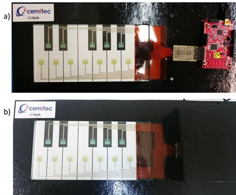
Figura 7.16. Dispositivo impreso: a) electrónica conectada a la parte flexible; b) piano con la parte electrónica oculta.
