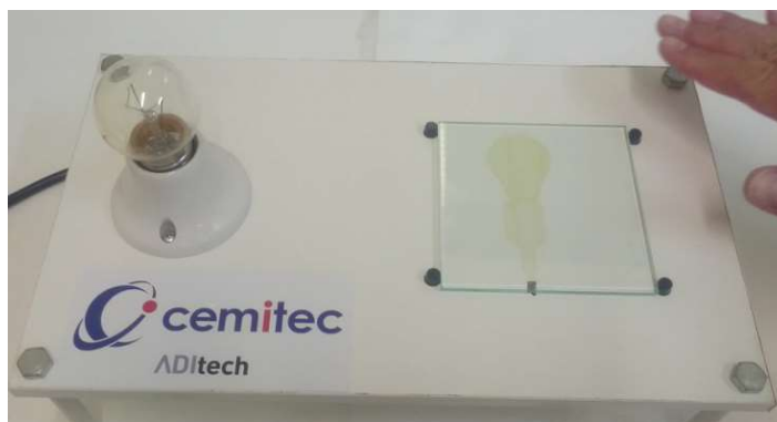
Figura 7.5. Imagen del dispositivo mostrando la bombilla y el electrodo de ITO sobre vidrio.
