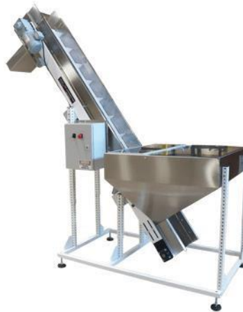
Figura 15. Tolva de alimentación con salida de cinta transportadora. Fuente: (Direct industry, 2018)
