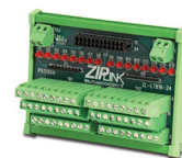
ZL-LTB16-24 sensor input module
