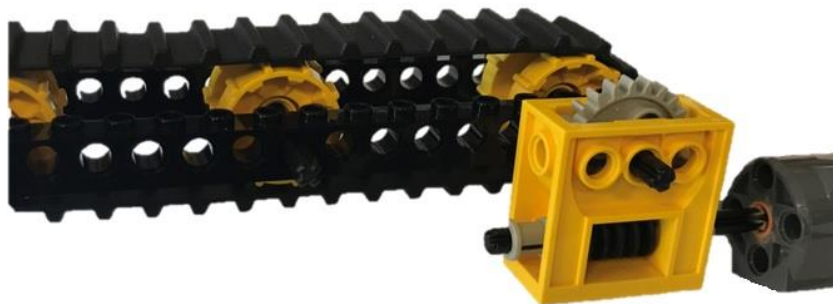
Ilustración 14 - Conjunto cinta-motor completo
