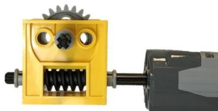
Ilustración 11 - Reductora acoplada al motor
