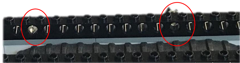
Ilustración 20 – Fototransistor receptor infrarrojos integrado en el ladrillo
