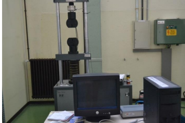
Figura-36. Fotografía de la máquina de tracción del laboratorio.
