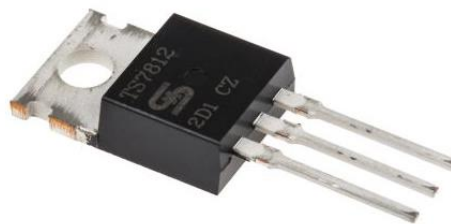
Fig33. Regulador de tensión lineal 12 V
