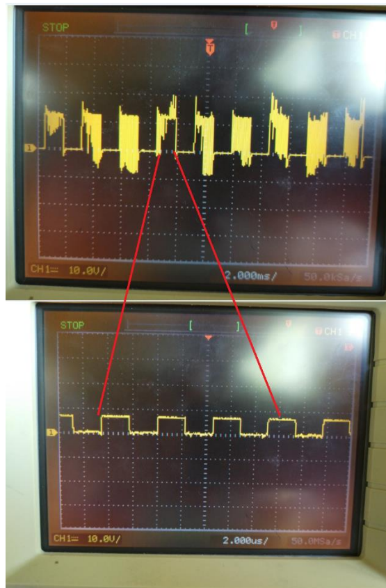
Fig49. Prueba de conmutación
